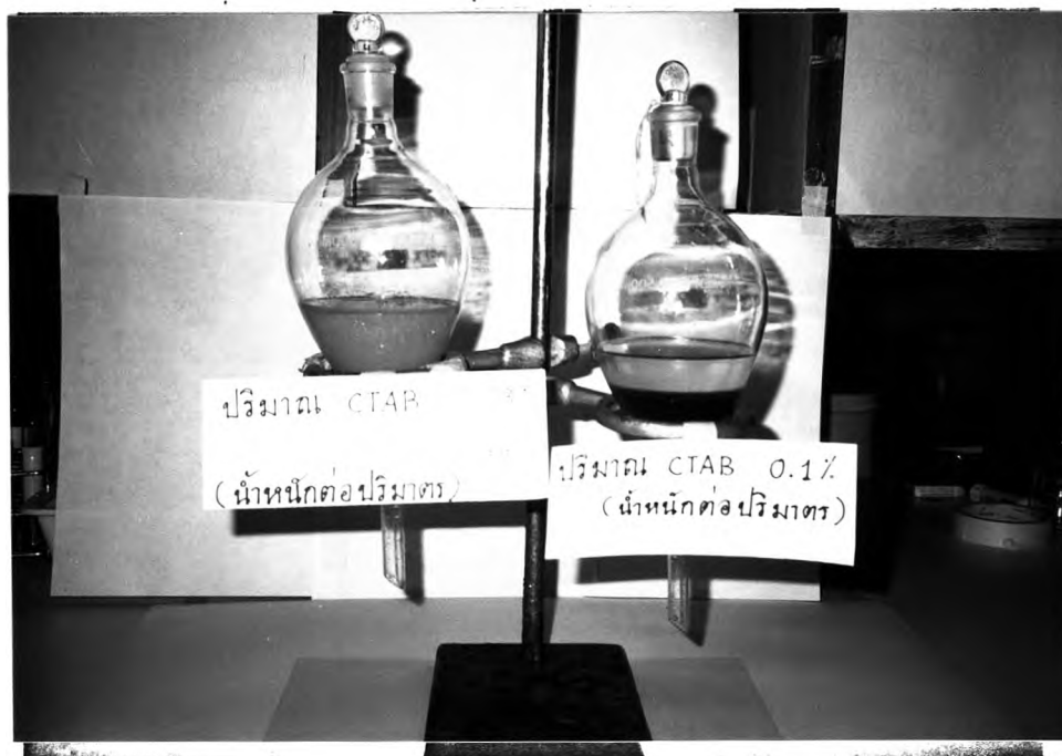
รูปที่ 8 ลักษณะของการแยกชั้นระหว่างน้ำหมักกับเอมิลอะซิเตต เมื่อเติมซิติลไตรเมททิลแอมโมเนียมโบรไมด์ (CTAB) 0.03% , 0.05% , 0.07% และ 0.1% (น้ำหนักต่อปริมาตร)
