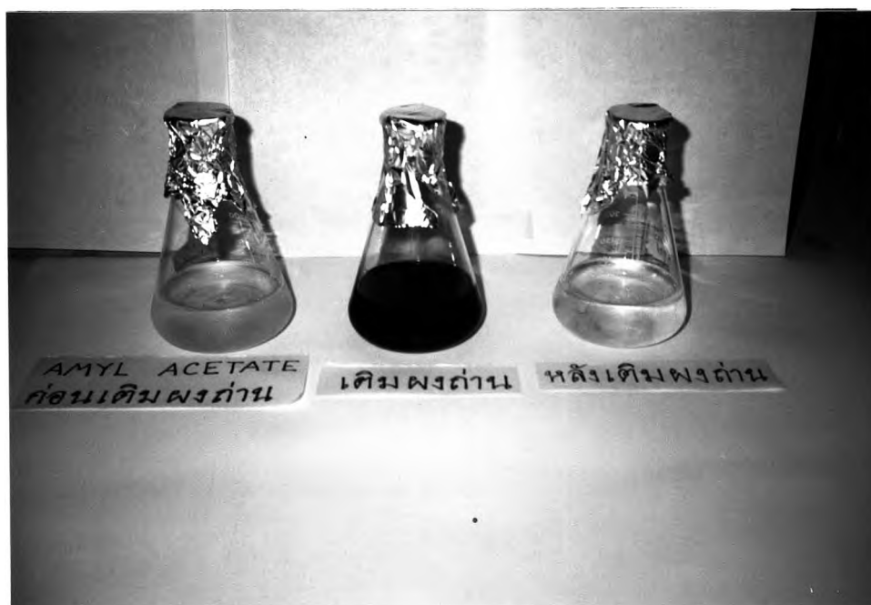
รูปที่ 14 เอมิลอะซิเตตที่ผ่านการสกัดก่อนเติมผงถ่าน และหลังเติมผงถ่านที่เวลา 30 นาที และใช้ปริมาณผงถ่าน 0.2 , 0.3 , 0.4 และ 0.5% (กรัมต่อ 100 มิลลิลิตร)
