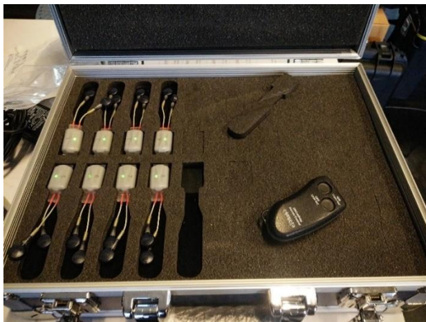
ภาพที่ 17 แสดงอิเล็กโทรดแบบวางที่ผิวหนัง (Surface measuring electrode)
