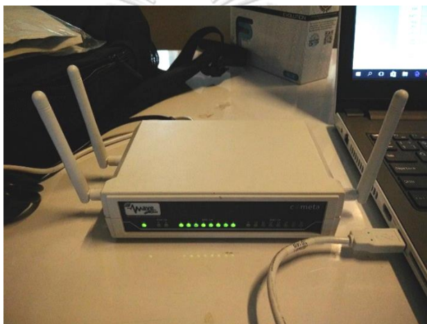
ภาพที่ 18 แสดงตัวรับสัญญาณคลื่นไฟฟ้ากล้ามเนื้อแบบไร้สาย (Wireless)
