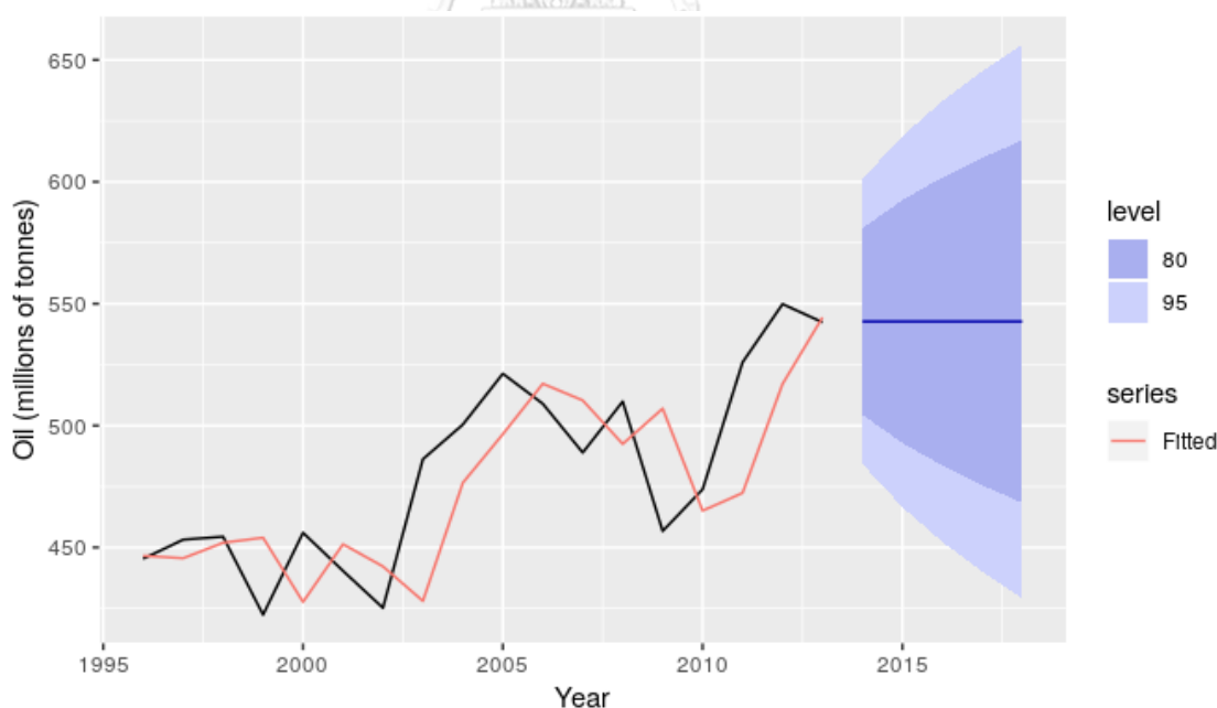
ภาพที่ 2.1 ตัวอย่างกราฟพยากรณ์ข้อมูลการผลิตน้ำมันประเทศซาอุดีอาระเบีย ปีค.ศ. 1996-2013 โดยวิธี SES
