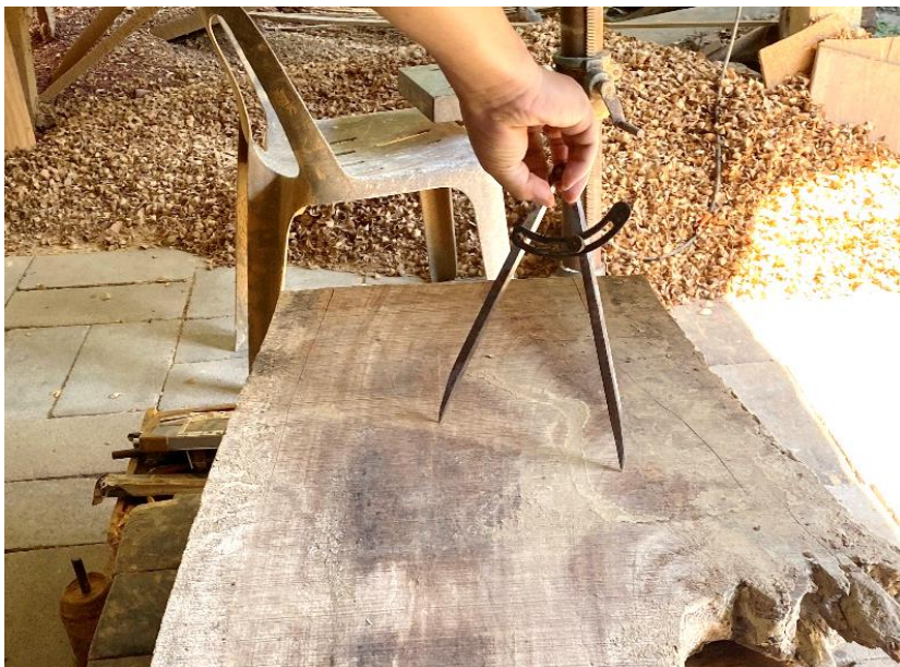
ภาพที่ 4.31 การวัดตำแหน่งกึ่งกลางกล่องเสียงด้วยวงเวียนเหล็ก ที่มาภาพ: ผู้วิจัยบันทึกภาพเมื่อวันที่ 16 พฤศจิกายน 2563
