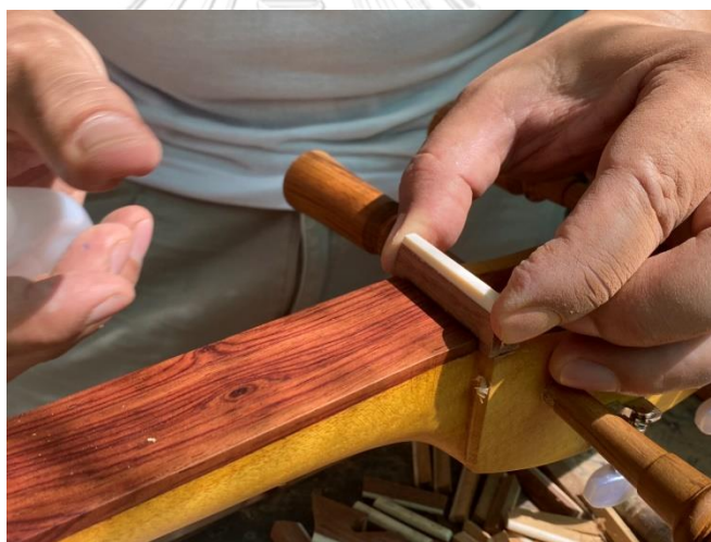
ภาพที่ 4.110 การใช้น้กดหย่องเพื่อให้ยึดติดกับฐานล่าง ที่มาภาพ: ผู้วิจัยบันทึกภาพเมื่อวันที่ 18 พฤศจิกายน 2563
