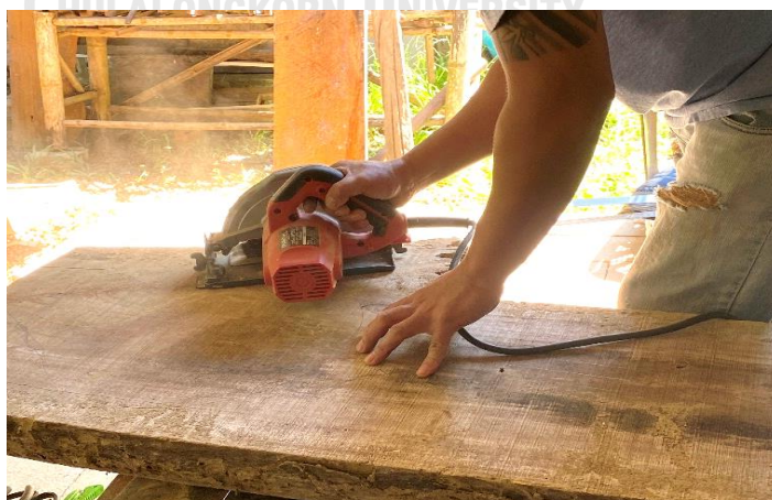
ภาพที่ 4.37 การใช้เลื่อยวงเดือนผ่าไม้ให้ได้โครงตามลายเส้นที่วาดด้วยดินสอ ที่มาภาพ: ผู้วิจัยบันทึกภาพเมื่อวันที่ 16 พฤศจิกายน 2563
