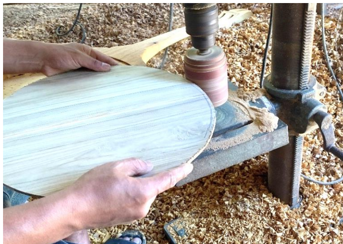
ภาพที่ 4.67 การขัดแต่งขอบมุมโค้งบริเวณรอยเชื่อมบัวบนและบัวล่าง ที่มาภาพ: ผู้วิจัยบันทึกภาพเมื่อวันที่ 17 พฤศจิกายน 2563
