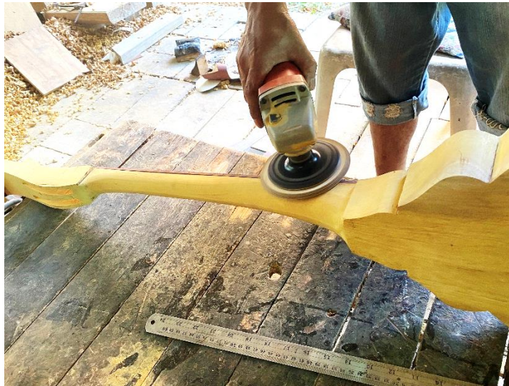
ภาพที่ 4.93 การใช้ลูกหมูขัดกระดาษทรายหยาบ เบอร์ P60 ที่มาภาพ: ผู้วิจัยบันทึกภาพเมื่อวันที่ 18 พฤศจิกายน 2563
