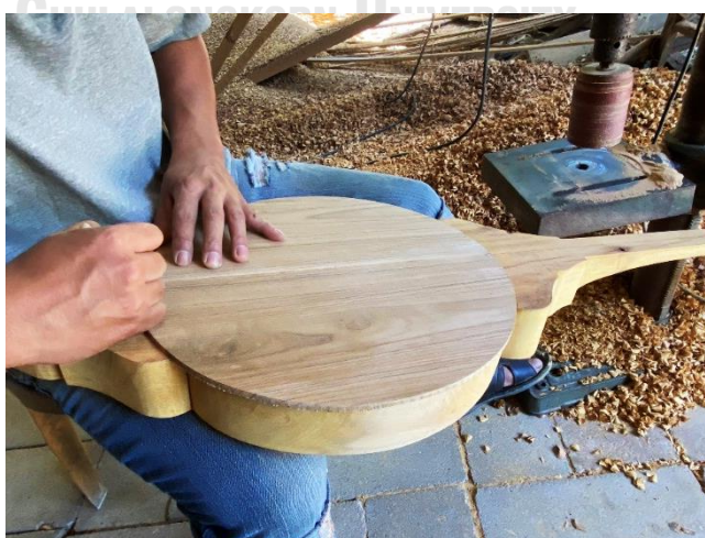
ภาพที่ 4.66 การวัดตำแหน่งกึ่งกลางแผ่นหน้าตาต ที่มาภาพ: ผู้วิจัยบันทึกภาพเมื่อวันที่ 17 พฤศจิกายน 2563
