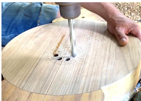
ภาพที่ 4.79 การใช้สว่านแทนเจาะรูรอบวงกลมตำแหน่งที่ 2 ที่มาภาพ: ผู้วิจัยบันทึกภาพเมื่อวันที่ 17 พฤศจิกายน 2563
