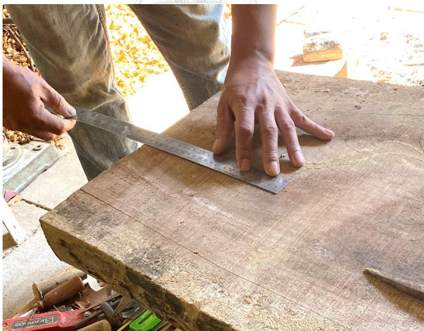
ภาพที่ 4.32 การวัดสัดส่วนตำแหน่งกึ่งกลางเพื่อให้เชื่อมโยงระหว่างบัวด้านล่างกับกล่องเสียง ที่มาภาพ: ผู้วิจัยบันทึกภาพเมื่อวันที่ 16 พฤศจิกายน 2563
