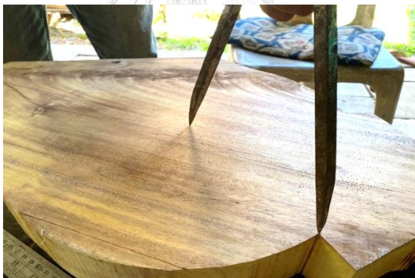
ภาพที่ 4.44 การใช้วงเวียนขีดเส้นวัดขอบกลอง ที่มาภาพ: ผู้วิจัยบันทึกภาพเมื่อวันที่ 16 พฤศจิกายน 2563
