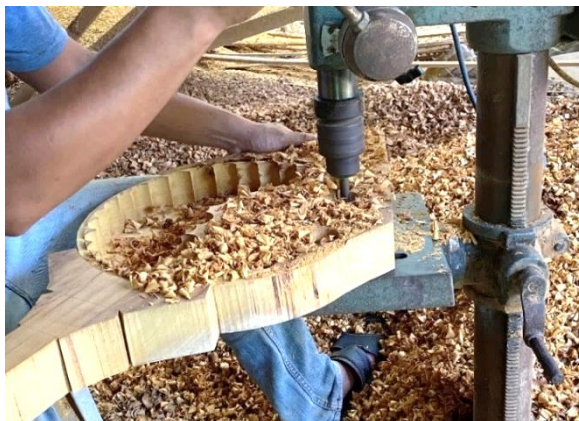
ภาพที่ 4.46 การใช้ส่วานแทนใส่ดอกชุดเจาะกล่องเสียง ที่มาภาพ: ผู้วิจัยบันทึกภาพเมื่อวันที่ 16 พฤศจิกายน 2563
