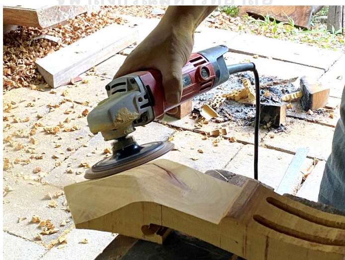
ภาพที่ 4.56 การใช้เครื่องขัดลูกหมูขัดแต่งมุมสันกระดูกงู ที่มาภาพ: ผู้วิจัยบันทึกภาพเมื่อวันที่ 16 พฤศจิกายน 2563
