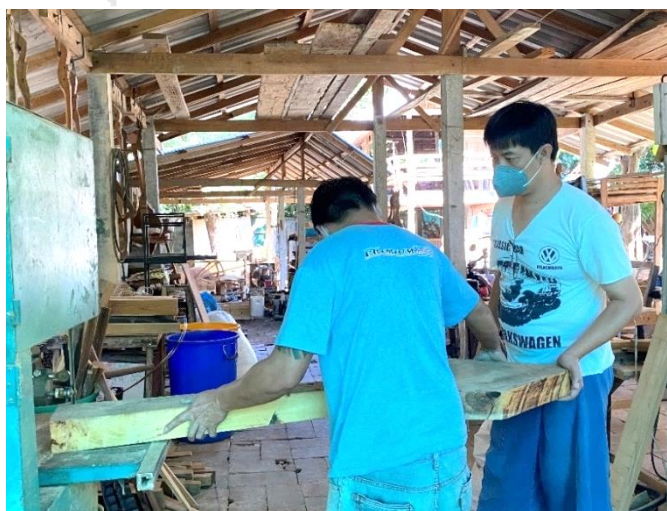
ภาพที่ 4.39 การผ่าไม้บริเวณหัวและคอซึ่งตัด
