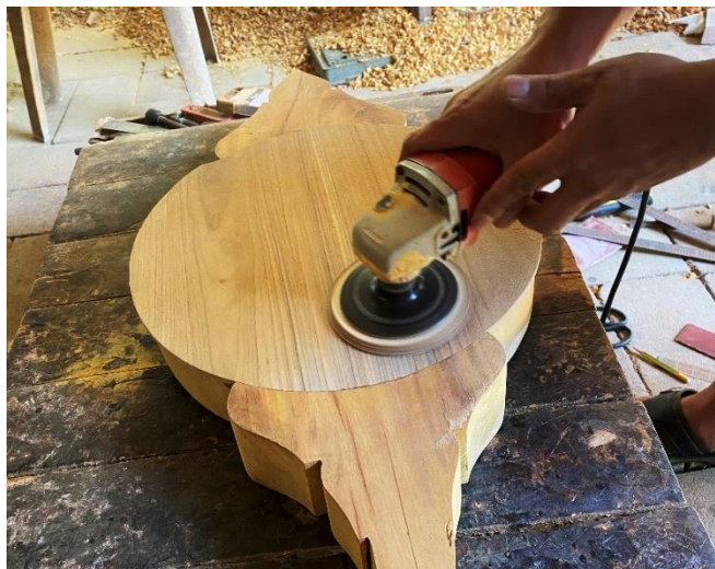
ภาพที่ 4.72 การใช้เครื่องขัดลูกหมูขัดแต่งรอยต่อบัวบน ที่มาภาพ: ผู้วิจัยบันทึกภาพเมื่อวันที่ 17 พฤศจิกายน 2563
