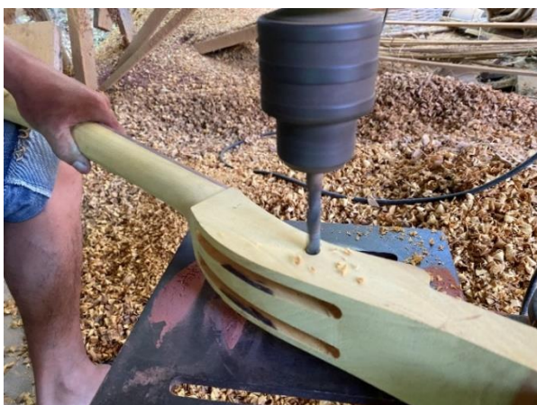
ภาพที่ 4.91 การใช้สว่านแท่นเจาะรูลูกบิดไม้
