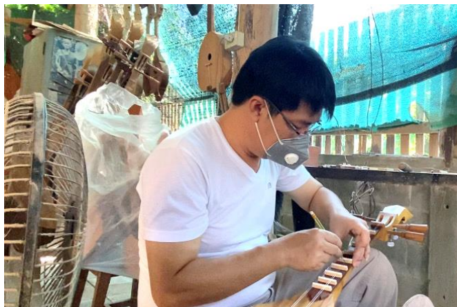
ภาพที่ 4.119 การใช้ดินสอดัดตำแหน่งที่จะวางลูกนับ ที่มาภาพ: ผู้วิจัยบันทึกภาพเมื่อวันที่ 18 พฤศจิกายน 2563
