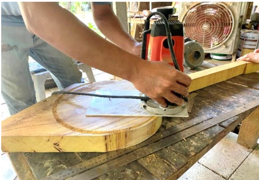
ภาพที่ 4.45 การใช้เร้าเตอร์เซาะร่องขอบกล่องให้ลึกลงไป 5 มิลลิเมตร ที่มาภาพ: ผู้วิจัยบันทึกภาพเมื่อวันที่ 16 พฤศจิกายน 2563
