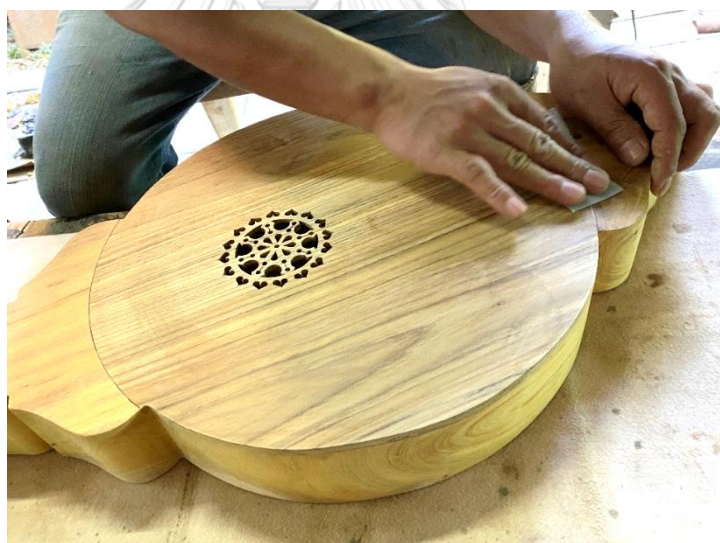
ภาพที่ 4.96 การขัดกระดาษทรายละเอียดเบอร์ 0 ที่มาภาพ: ผู้วิจัยบันทึกภาพเมื่อวันที่ 18 พฤศจิกายน 2563
