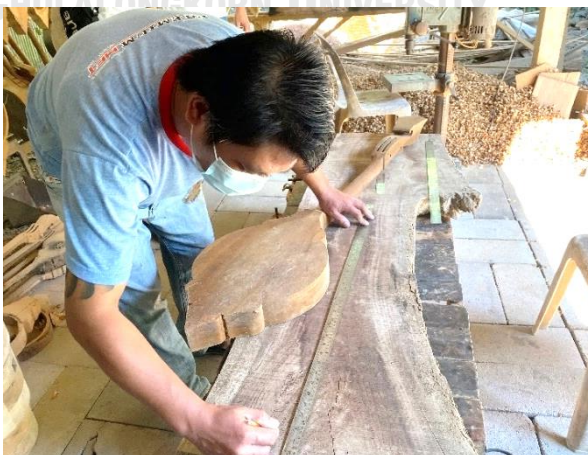
ภาพที่ 4.35 การวัดสัดส่วนของคอให้เชื่อมโยงกับกล่องเสียง ที่มาภาพ: ผู้วิจัยบันทึกภาพเมื่อวันที่ 16 พฤศจิกายน 2563
