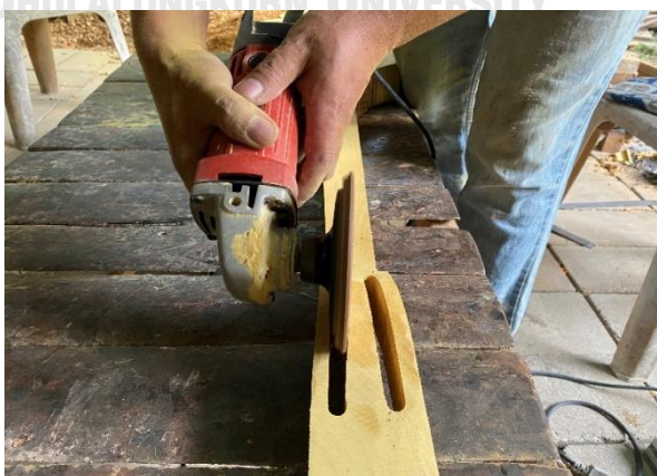
ภาพที่ 4.54 การใช้เครื่องขัดลูกหมูขัดแต่งช่องรางไหมให้เรียบ ที่มาภาพ: ผู้วิจัยบันทึกภาพเมื่อวันที่ 16 พฤศจิกายน 2563
