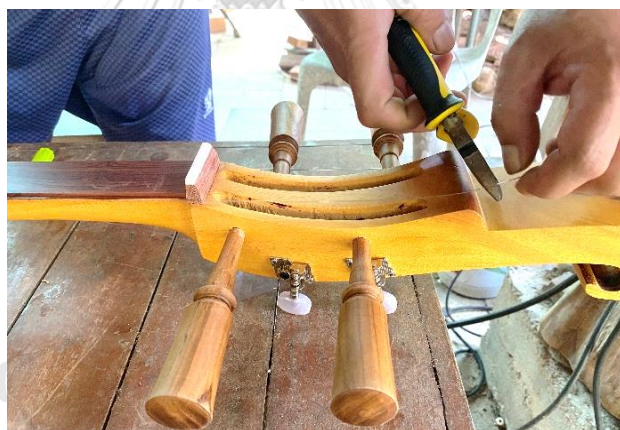
ภาพที่ 4.112 การวัดระยะความยาวของสายจากหลังซึ่งถึงปลายรางไหม ที่มาภาพ: ผู้วิจัยบันทึกภาพเมื่อวันที่ 18 พฤศจิกายน 2563
