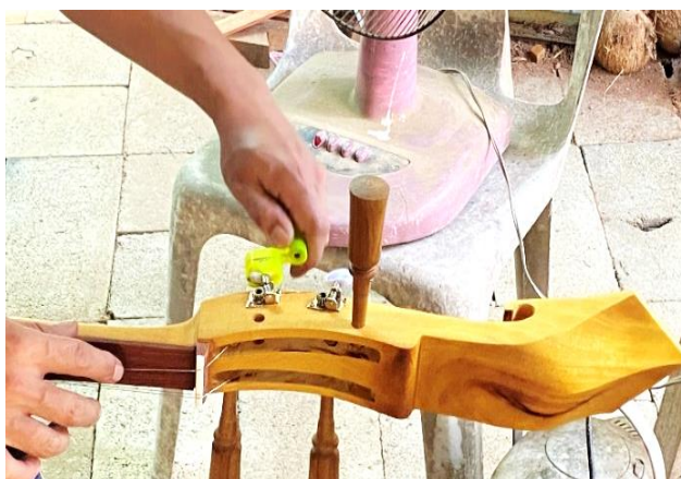
ภาพที่ 4.113 การหมุนลูกบิดกีตาร์เพื่อปรับความตึงหย่อนของสาย
