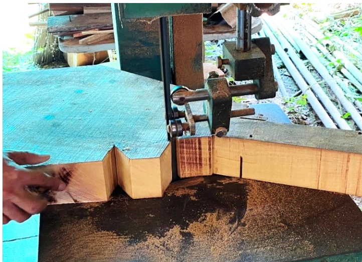
ภาพที่ 4.40 การผ่าเข้ามุมบริเวณบัวด้านบนของกล่องเสียง ที่มาภาพ: ผู้วิจัยบันทึกภาพเมื่อวันที่ 16 พฤศจิกายน 2563
