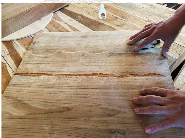
ภาพที่ 4.61 การนำแผ่นไม้สักมาประกบติดกันและทาด้วยกาวร้อน ที่มาภาพ: ผู้วิจัยบันทึกภาพเมื่อวันที่ 17 พฤศจิกายน 2563
