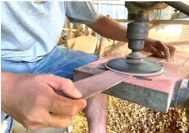
ภาพที่ 4.84 การนำแผ่นไม้ที่ผ่ามาขัดกับกระดาษทรายเบอร์ P60 ที่มาภาพ: ผู้วิจัยบันทึกภาพเมื่อวันที่ 17 พฤศจิกายน 2563
