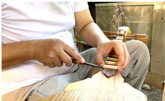
ภาพที่ 4.121 การใช้สิ่วเจาะร่องเปิดหน้าสีออก ที่มาภาพ: ผู้วิจัยบันทึกภาพเมื่อวันที่ 18 พฤศจิกายน 2563
