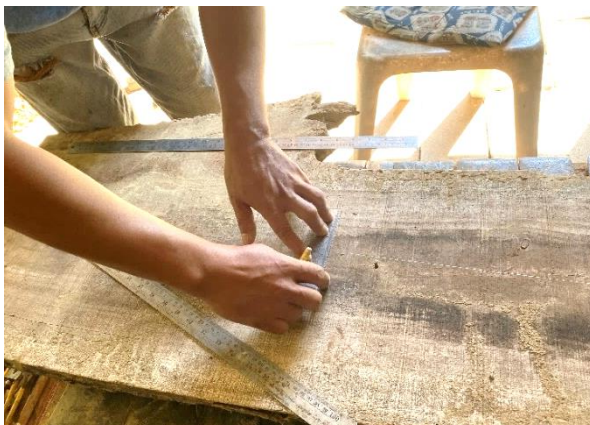
ภาพที่ 4.33 การวัดสัดส่วนเชื่อมโยงระหว่างบัวด้านบนกับกล่องเสียง ที่มาภาพ: ผู้วิจัยบันทึกภาพเมื่อวันที่ 16 พฤศจิกายน 2563
