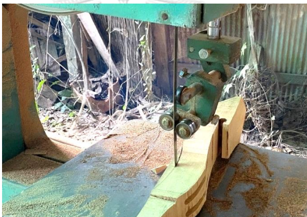
ภาพที่ 4.53 การใช้เลื่อยสายพานผ่าเข้าโค้งหน้ารางไหม ที่มาภาพ: ผู้วิจัยบันทึกภาพเมื่อวันที่ 16 พฤศจิกายน 2563
