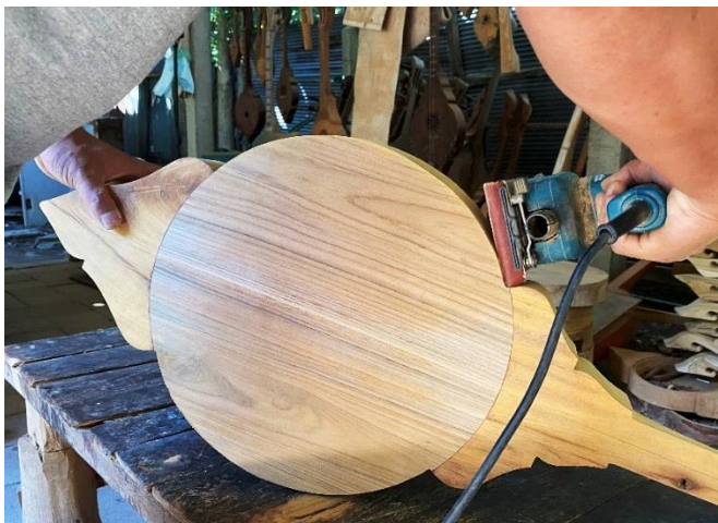
ภาพที่ 4.74 การใช้เครื่องจักรถึงขัดแต่งขอบรอยต่อแผ่นหน้าตาตและกล่องเสียง ที่มาภาพ: ผู้วิจัยบันทึกภาพเมื่อวันที่ 17 พฤศจิกายน 2563
