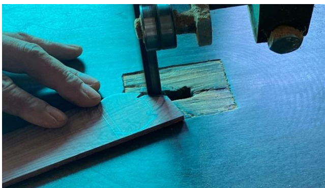
ภาพที่ 4.86 การนำลายที่วาดมาฝักกับเลื่อยสายพาน
