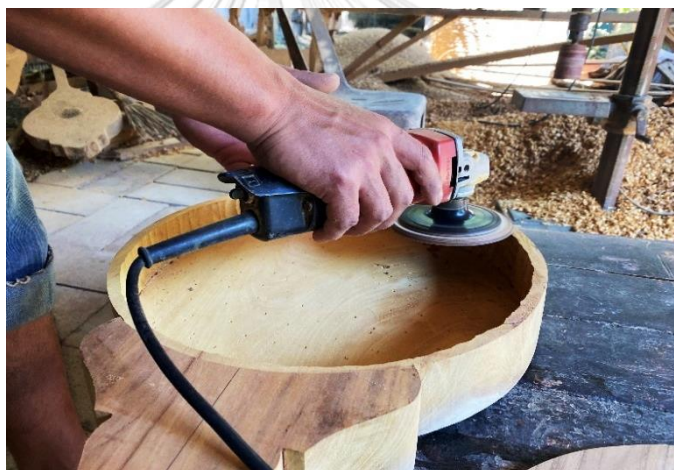
ภาพที่ 4.68 การใช้เครื่องขัดลูกหมูขัดแต่งขอบกล่องเสียง ที่มาภาพ: ผู้วิจัยบันทึกภาพเมื่อวันที่ 17 พฤศจิกายน 2563
