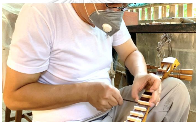
ภาพที่ 4.120 การใช้ใบเลื่อยช่างทองขีดผิวไม้ให้เป็นร่อง ที่มาภาพ: ผู้วิจัยบันทึกภาพเมื่อวันที่ 18 พฤศจิกายน 2563
