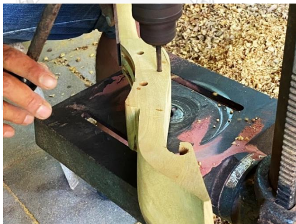
ภาพที่ 4.92 การใช้สว่านแท่นเจาะรูลูกบิดกีดาร์
