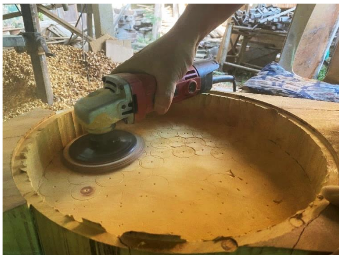
ภาพที่ 4.48 การใช้เครื่องขัดลูกหมูแต่งผิวไม้ให้เรียบเนียน ที่มาภาพ: ผู้วิจัยบันทึกภาพเมื่อวันที่ 16 พฤศจิกายน 2563
