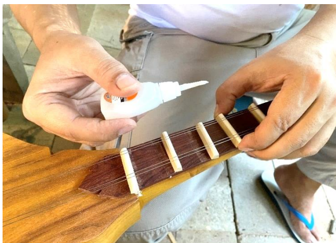
ภาพที่ 4.122 การหยอดกาวร้อนลงบนร่องที่เซาะไว้ ที่มาภาพ: ผู้วิจัยบันทึกภาพเมื่อวันที่ 18 พฤศจิกายน 2563
