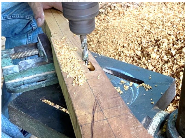
ภาพที่ 4.50 การเจาะรูรางใหม่ด้วยสว่านแทน ที่มาภาพ: ผู้วิจัยบันทึกภาพเมื่อวันที่ 16 พฤศจิกายน 2563 จุฬาลงกรณ์มหาวิทยาลัย
