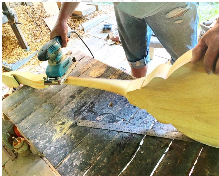
ภาพที่ 4.94 การขัดกระดาษทรายละเอียดเบอร์ P100 ด้วยเครื่องขัดกบไฟฟ้า ที่มาภาพ: ผู้วิจัยบันทึกภาพเมื่อวันที่ 18 พฤศจิกายน 2563
