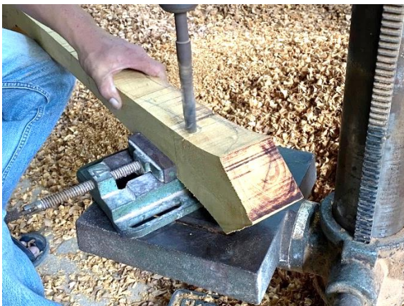
ภาพที่ 4.52 การใช้สว่านแทนเจาะรูหัวซึ่ง ที่มาภาพ: ผู้วิจัยบันทึกภาพเมื่อวันที่ 16 พฤศจิกายน 2563
