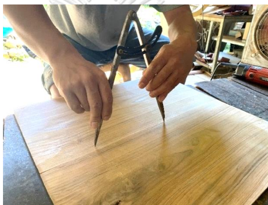
ภาพที่ 4.63 การใช้วงเวียนขีดเส้นวาดแผ่นหน้าตาดเป็นวงกลม ที่มาภาพ: ผู้วิจัยบันทึกภาพเมื่อวันที่ 17 พฤศจิกายน 2563
