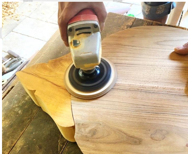
ภาพที่ 4.73 การใช้เครื่องขัดลูกหมูขัดแต่งรอยต่อบัวล่าง ที่มาภาพ: ผู้วิจัยบันทึกภาพเมื่อวันที่ 17 พฤศจิกายน 2563
