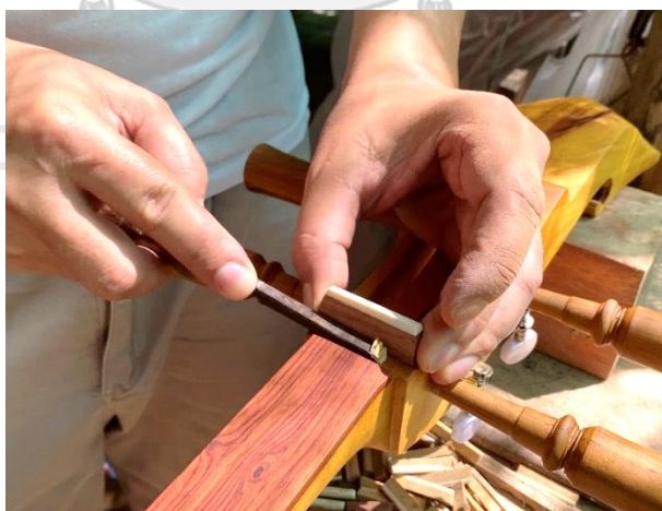
ภาพที่ 4.108 การใช้สิ่วเซาะร่องเปิดหน้าสีที่เคลือบไว้ออก ที่มาภาพ: ผู้วิจัยบันทึกภาพเมื่อวันที่ 18 พฤศจิกายน 2563
