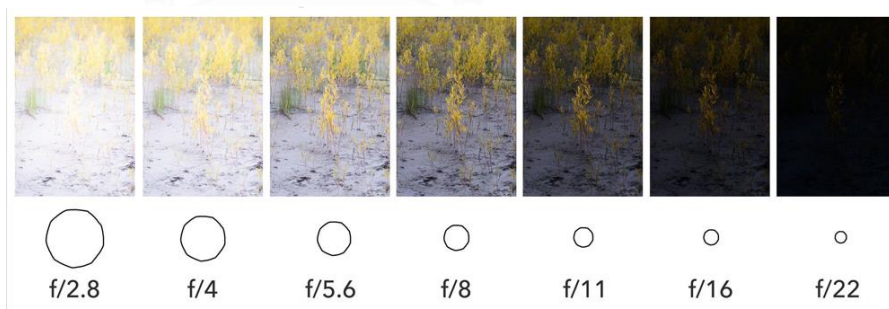
ภาพที่ 2.18 ความสว่างของภาพเมื่อมีการเปลี่ยนแปลงของรูรับแสง ที่มา https://www.photoschoolthailand.com/basic-aperture-photography วันที่สืบค้นออนไลน์ 30 พฤศจิกายน 2563
