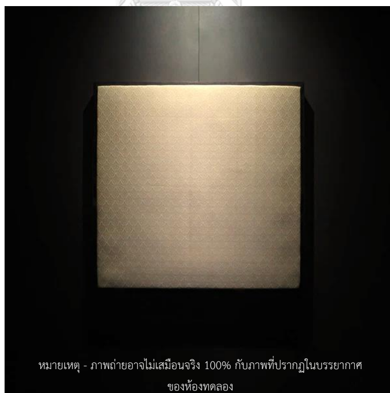
ภาพที่ 3.43 ผ้าไหมยกดอกเส้นทอง ส่องสว่างทิศขนานกับเส้นพุ่ง (0°) ร่วมกับแสง 4000K
