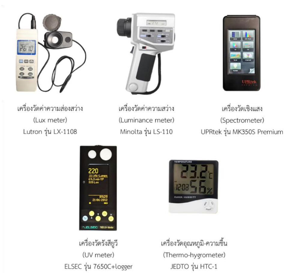
ภาพที่ 3.29 เครื่องมือและอุปกรณ์ในการวัดค่าต่าง ๆ
