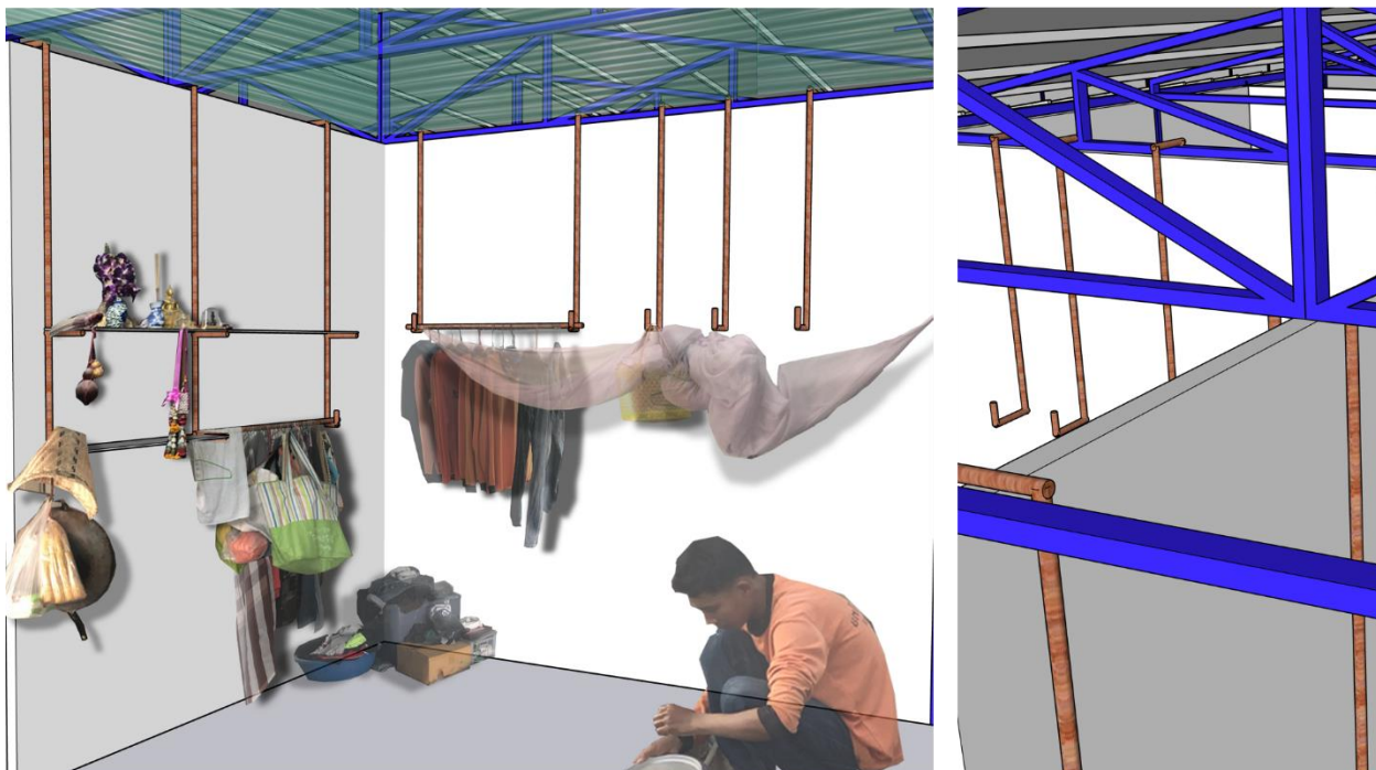
ภาพที่ 6.16 แสดงการต่อเติมในแนวตั้งเพื่อเพิ่มพื้นที่ใช้สอยภายในห้องพักด้วยวิธีแขวน แขนงวิธีการเจาะ และเชื่อม
