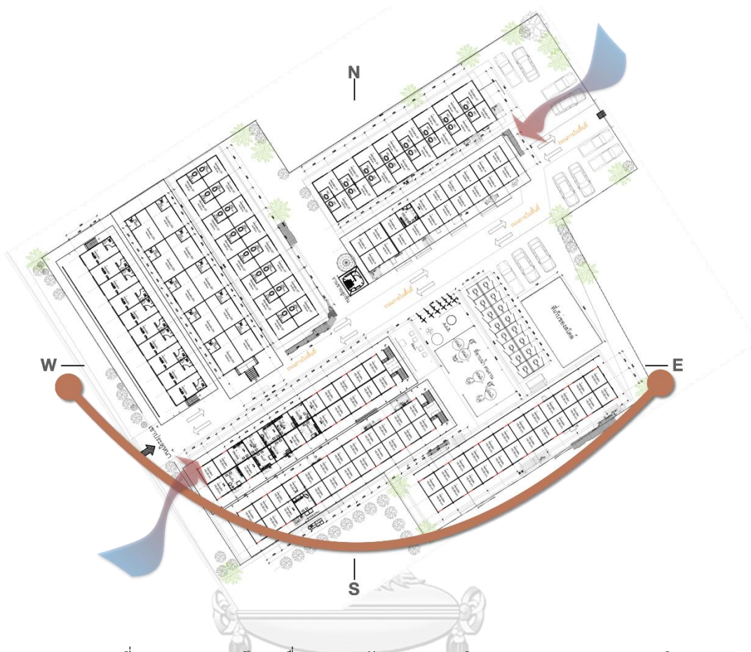
ภาพที่ 6.14 แสดงการศึกษาเรื่องการวางผังอาคาร และทิศทางผลกระทบจากธรรมชาติ
