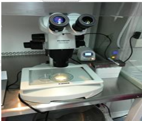
รูปภาพที่ 8 เซลล์ไข่ในจานทดลองซึ่งควบคุมผ่าน plate warmer ให้มีอุณหภูมิ 37 องศาเซลเซียส (หมายเลข 4 ในผัง)
