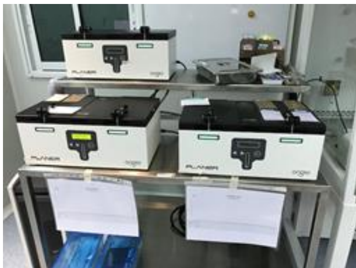
รูปภาพที่ 9 ตู้อบ Planer BT37 ซึ่งบรรจุจานที่มีไข่ (รอผสม) และตัวอ่อนที่ผสมแล้ว ถูกควบคุมอุณหภูมิไว้ที่ 37 องศาเซลเซียส (หมายเลข 5 ในผัง)
