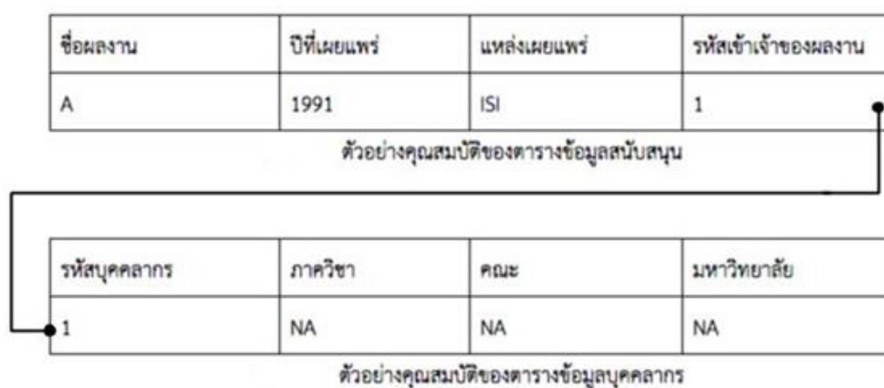
ภาพที่ 5 - 2 การเชื่อมโยงข้อมูลด้วยกุญแจระหว่างตารางข้อมูลสนับสนุนและข้อมูลบุคลากร ที่มา : ผู้วิจัย
