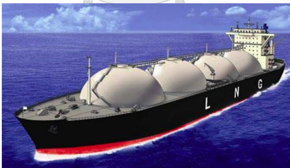
รูปที่ 2-3 แสดงเรือขนส่งก๊าซธรรมชาติเหลวแบบ MOSS Type
