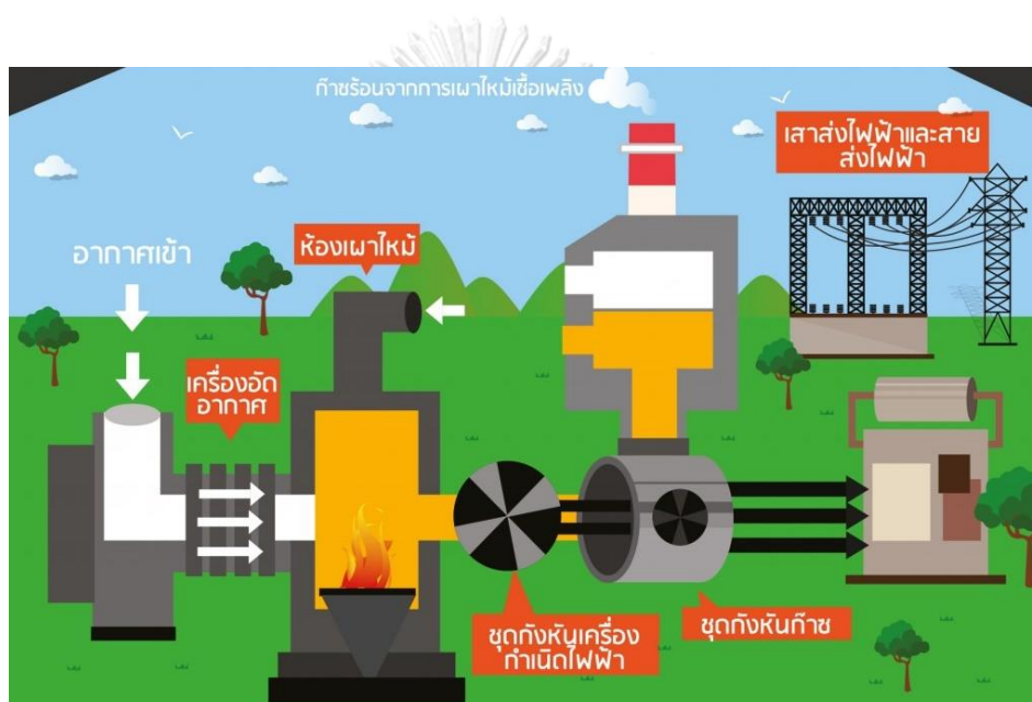
รูปที่ 2-10 แสดงโรงไฟฟ้าพลังความร้อนกังหันก๊าซ
