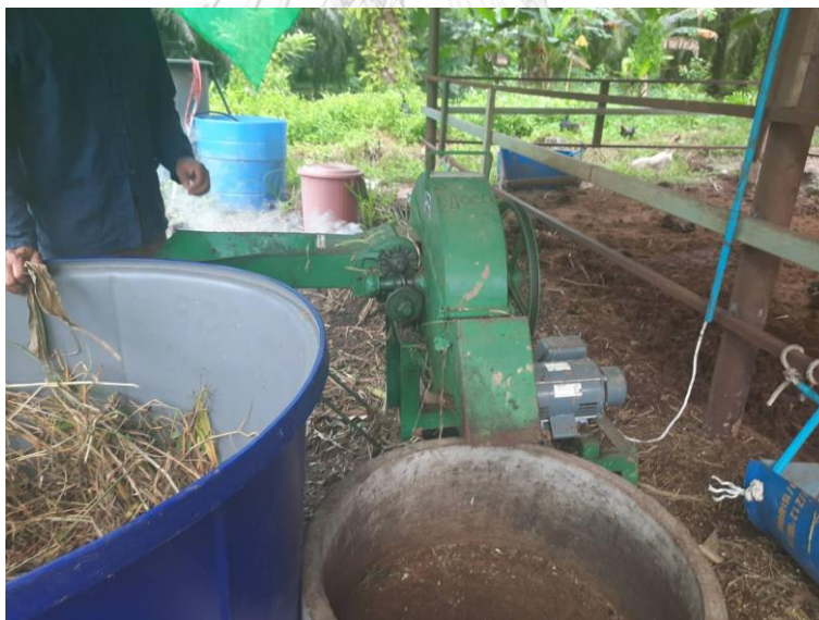
รูปที่ 36 เครื่องย่อยหญ้าจากทุนสมาชิกในกลุ่ม (จากการสำรวจพื้นที่ของผู้วิจัย, 2563)
