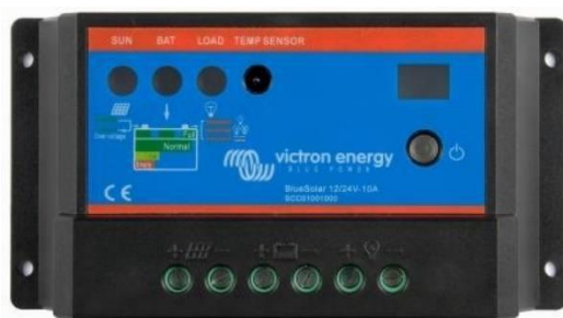
รูปที่ ก-5 ตัวควบคุมการชาร์จแบบ PWM ยี่ห้อ Victron 12 โวลต์ 10 แอมป์
