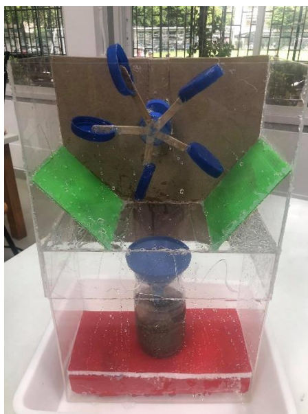
ภาพที่ 22 ผลงานนักเรียนกลุ่มที่ 12 อุปกรณ์ผลิตไฟฟ้าพร้อมกรองน้ำจากน้ำฝน
