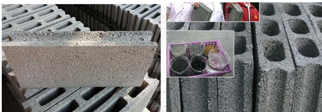
รูปที่ 2-5 อิฐบล็อกทั่วไป [13] (ซ้าย) และอิฐบล็อกมวลเบาซึ่งผสมเถ้าแกลบ [14] (ขวา)
