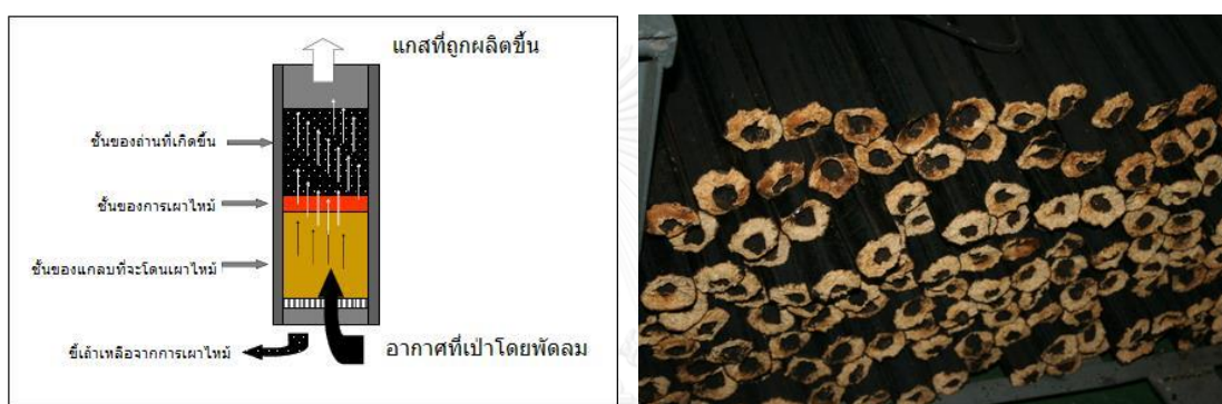
รูปที่ 2-3 เตาแก๊สชีวมวลซึ่งใช้แกลบเป็นแหล่งพลังงาน [9] (ซ้าย) และแกลบอัดแท่งสำหรับนำไปเผาเป็นถ่านแกลบ [10] (ขวา)
