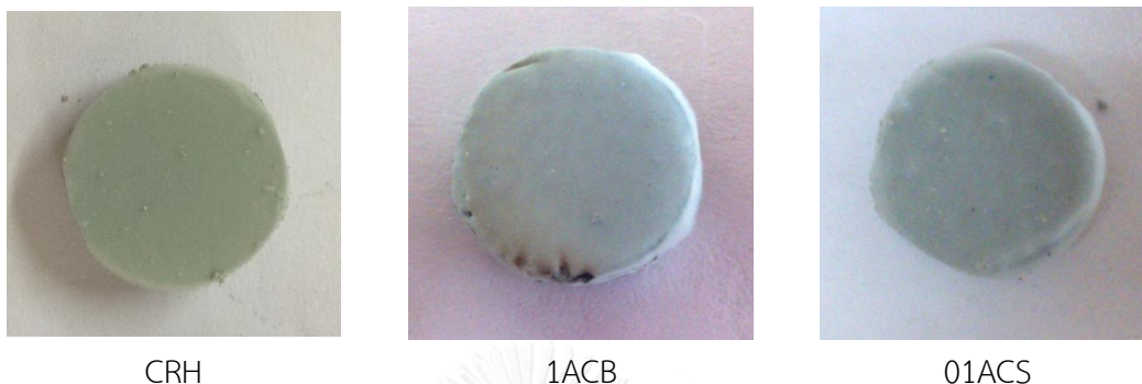
รูปที่ 4-14 ภาพถ่ายชิ้นงานหลังเผาที่อุณหภูมิ 1600 องศาเซลเซียส ภายใต้บรรยากาศอาร์กอน
