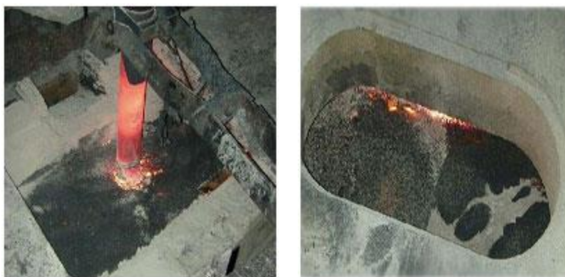
รูปที่ 2-2 การใช้เถ้าแกลบสำหรับโรยหน้าอ่างพักน้ำโลหะ [7]
