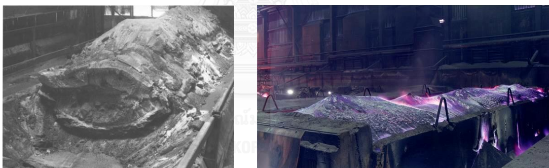
รูปที่ 2-12 เตา Acheson process และผลิตภัณฑ์ที่ได้จากการสังเคราะห์ซิลิคอนคาร์ไบด์ด้วยกระบวนการ Acheson [35, 37]
