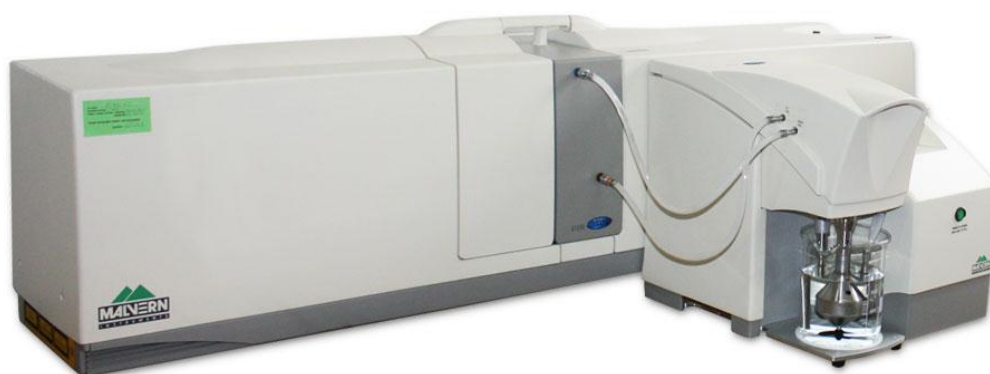
ภาพที่ 3.4 เครื่องวัดขนาดอนุภาค (particle size analyzer)
