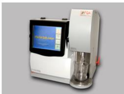
ภาพที่ 3.3 เครื่องวัดสัดส่วนวิทยาของเส้นใย (FQA)
