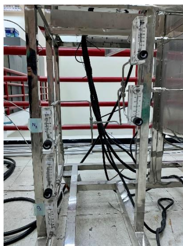
รูปที่ 3.10 ส่วนควบคุมอัตราการไหลของแก๊ส
