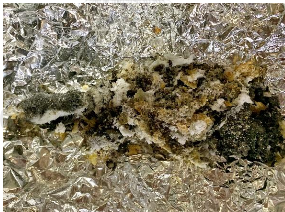
รูปที่ 4.2 พอลิเอทิลีนแวกซ์ละลายและสีเกิดการเปลี่ยนแปลงเมื่อใช้อุณหภูมิสูงกว่า 123 องศาเซลเซียส
