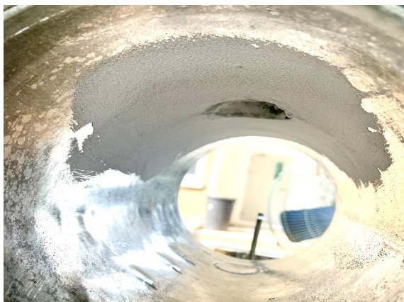
รูปที่ 4.4 ผลิตรถยนต์ออกซีไดซ์พอลิเอทิลีนแวกซ์บางส่วนติดอยู่บริเวณพื้นผิวภายในเครื่องปฏิกรณ์ เมื่อใช้ปริมาณสารเพอร์ออกไซด์อินทรีย์มากกว่าร้อยละ 8 โดยน้ำหนัก
