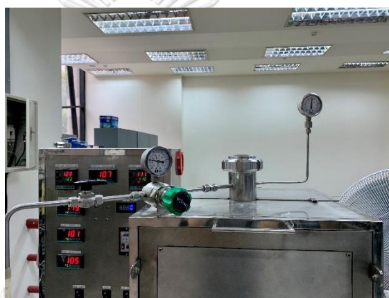
รูปที่ 3.6 เกจวัดความดันและวาล์วควบคุมความดันย้อนกลับ
