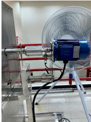
รูปที่ 3.8 ไขพัดใช้กวนสารซึ่งต่ออยู่กับมอเตอร์
