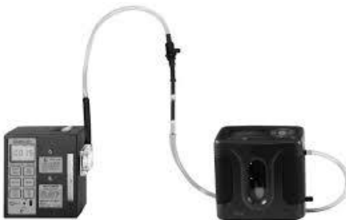
รูปที่ 3.17 การปรับเทียบอัตราการไหลของอากาศในการเก็บสารประกอบอินทรีย์ระเหยง่าย (VOCs)
