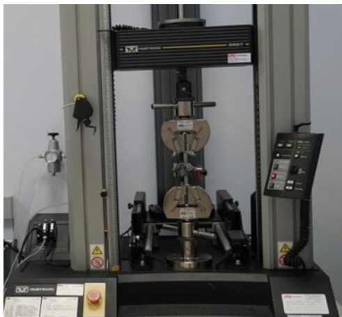
รูปที่ 3.10 เครื่องทดสอบสมบัติด้านความทนแรงดึง
