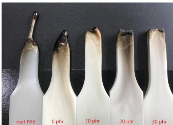
รูปที่ 4.35 ชิ้นงานหลังทดสอบการหลอมหายของ PA6 และ 85/15/x PA6/EOC-g-MAWT คอมพอสิตด้วย WT ที่ปริมาณ 0, 10, 20 และ 30 phr
