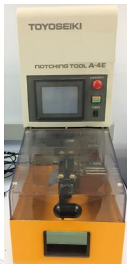
รูปที่ 3.8 เครื่องบากชิ้นงาน
