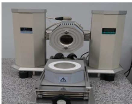
รูปที่ 3.20 เครื่องทดสอบสมบัติเชิงพลวัต (DMA)
