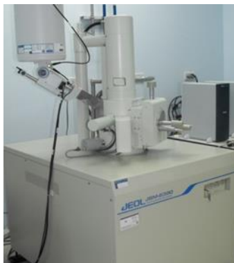
รูปที่ 3.4 กล้องจุลทรรศน์อิเล็กตรอนแบบส่องกราด
