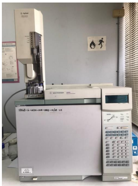
รูปที่ 3.4 เครื่องแก๊สโครมาโทกราฟ ยี่ห้อ Agilent รุ่น 6890N
