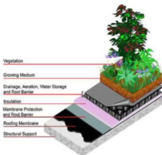
รูปที่ 2.2 โครงสร้างของหลังคาเขียว
