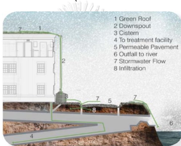
รูปที่ 2.7 ระบบการจัดการน้ำด้วยโครงสร้างพื้นฐานสีเขียว
