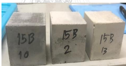
รูปที่ 9 มอร์ต้าได้รับความร้อนที่ อุณหภูมิห้อง(ซ้าย) 400°C (กลาง) และ 800°C (ขวา)
