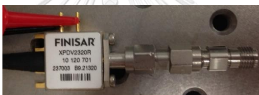
รูปที่ 2.21 ตัวตรวจจับแสงชนิดพีไอเอเอ็น รุ่น XPDV2320R ของบริษัท Finisar
