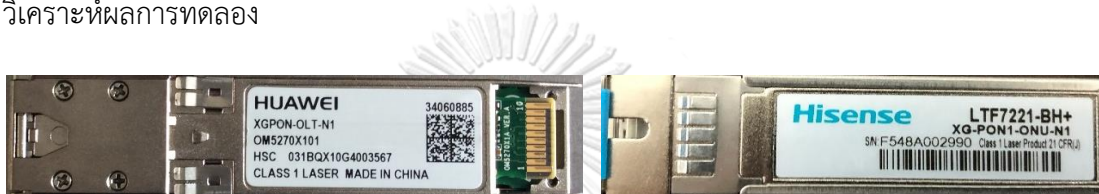
รูปที่ 1.3 โมดูลรับส่งของ (ซ้าย) เครื่องโอแอลที และ (ขวา) เครื่องโอเอ็นยู บริษัท Huawei
