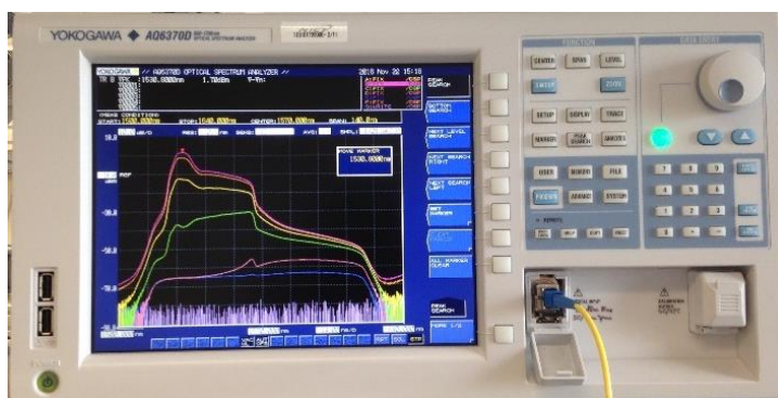
รูปที่ 2.23 เครื่องวิเคราะห์สเปกตรัมแสง รุ่น AQ6370D ของบริษัท Yokogawa
