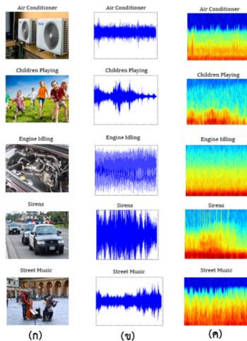
รูปที่ 3.64 คุณลักษณะของเสียงสภาพแวดล้อม 5 ประเภท (ก) ชนิดของเสียง (ข) สัญญาณโดเมนทางเวลา และ (ค) สัญญาณโดเมนทางเวลา-ความถี่
