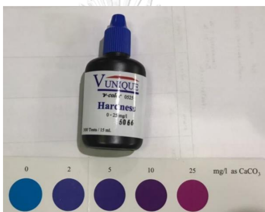
รูปที่ 1.3 การแปลผลการทดสอบความกระด้างของน้ำอ่อนที่หน้างาน
