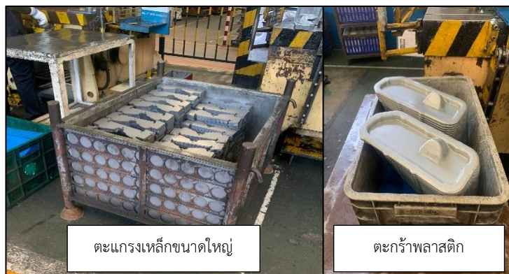
รูปที่ 5.6 อุปกรณ์ที่ใช้ในการขนย้ายสถานีงานก่อนและหลังปรับปรุง
