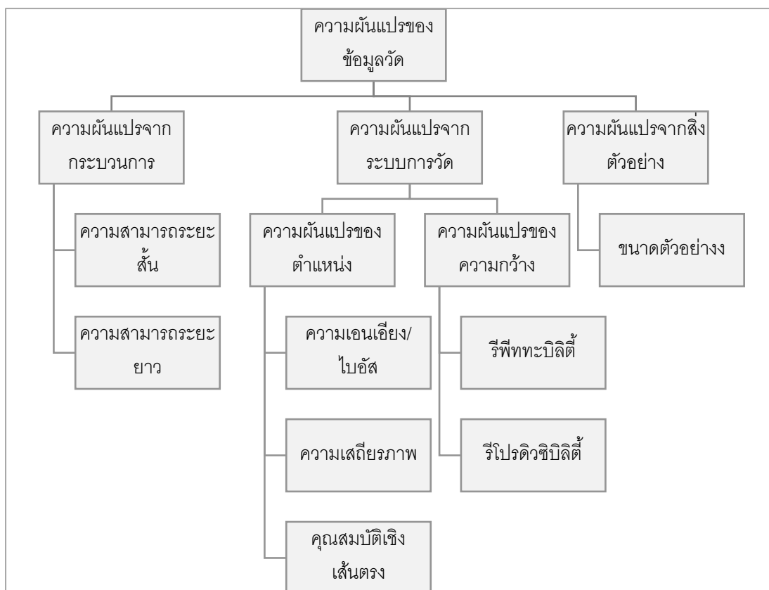
รูปที่ 2.2 องค์ประกอบของความผันแปรของระบบการวัด
