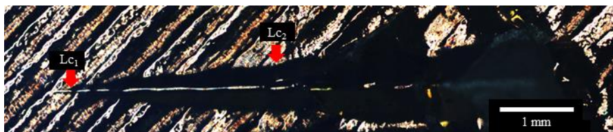
รูปที่ 4.11 รอยขีดข่วนของชั้นเคลือบโลหะทองแดงบนชิ้นงาน PLA ผ่านการเตรียมผิวด้วยวิธีการทาสีนำไฟฟ้า (วิธีที่ 3)
