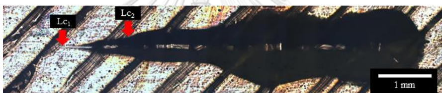
รูปที่ 4.8 รอยขีดข่วนของชั้นเคลือบโลหะทองแดงบนชิ้นงาน ABS ผ่านการเตรียมผิวด้วยวิธีการกัดผิวและแอคติเวทด้วยแพลเลเดียม (วิธีมาตรฐาน)
