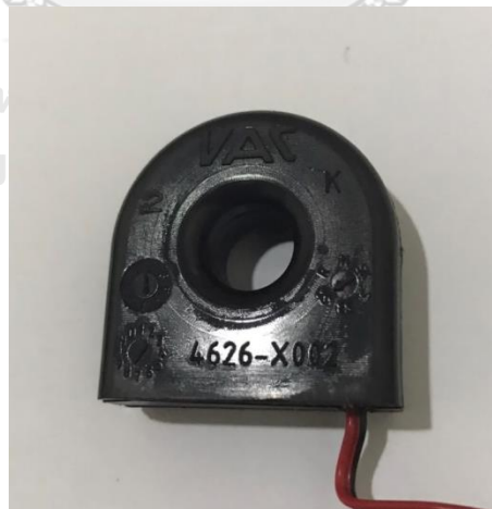
รูปที่ 33 หม้อแปลงกระแสไฟฟ้า VAC 4626-X002
