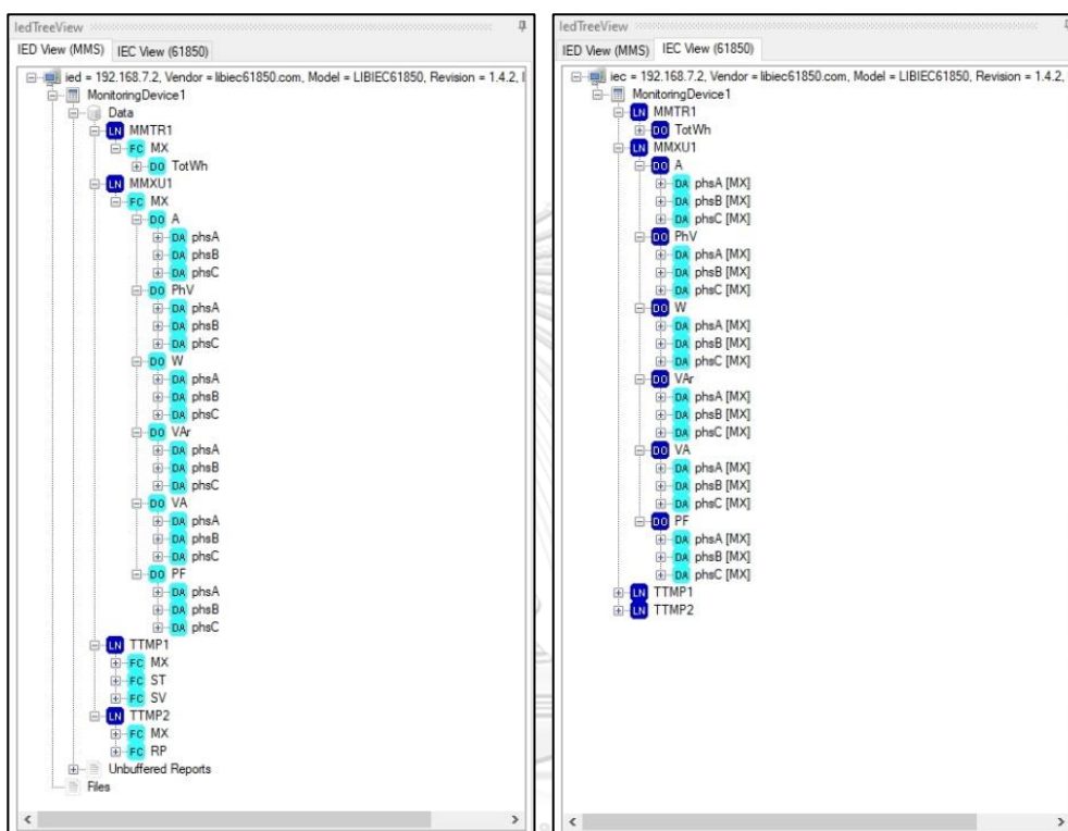
รูปที่ 82 ชุดข้อมูลตามมาตรฐาน IEC61850 ของอุปกรณ์เฝ้าสังเกตหม้อแปลงไฟฟ้าระบบจำหน่าย ในมุมมองของ ledTreeView
