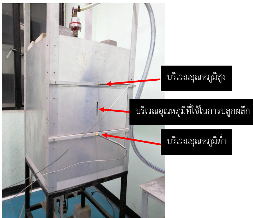
ภาพที่ 10 ระบบเตาหลอมผลึกโดยแบ่งเป็น 3 บริเวณ
