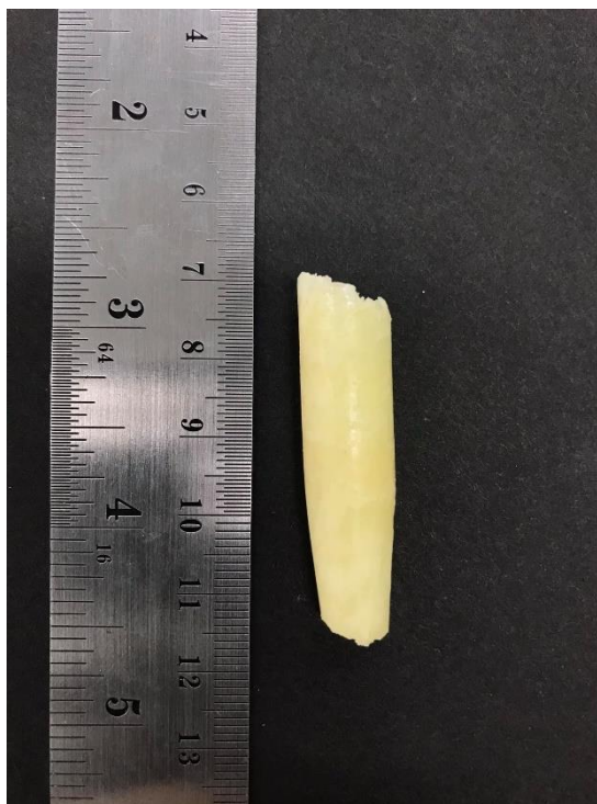
ภาพที่ 24 ผลึก \text{CsSrI}_3(\text{Tl}) ที่มีอัตราส่วน 95:5 หลังปลูกเสร็จ
