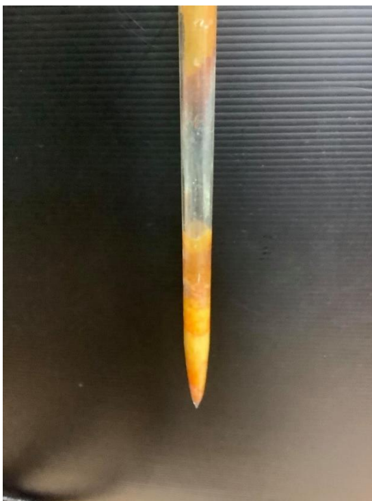
ภาพที่ 22 ผลึก CsSrI 3 (Tl) ที่มีอัตราส่วน 70:30 หลังปลุกเสร็จ
