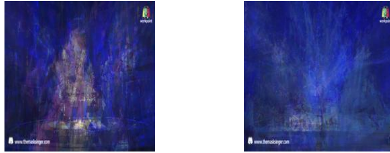
ภาพ 10 ภาพซ้าย ภาพที่เกิดจากการประมวลผลตัวกรองมัธยฐานด้วย 10 ภาพ ภาพขวา ภาพที่เกิดจากการประมวลผลตัวกรองมัธยฐานด้วย 20 ภาพ
