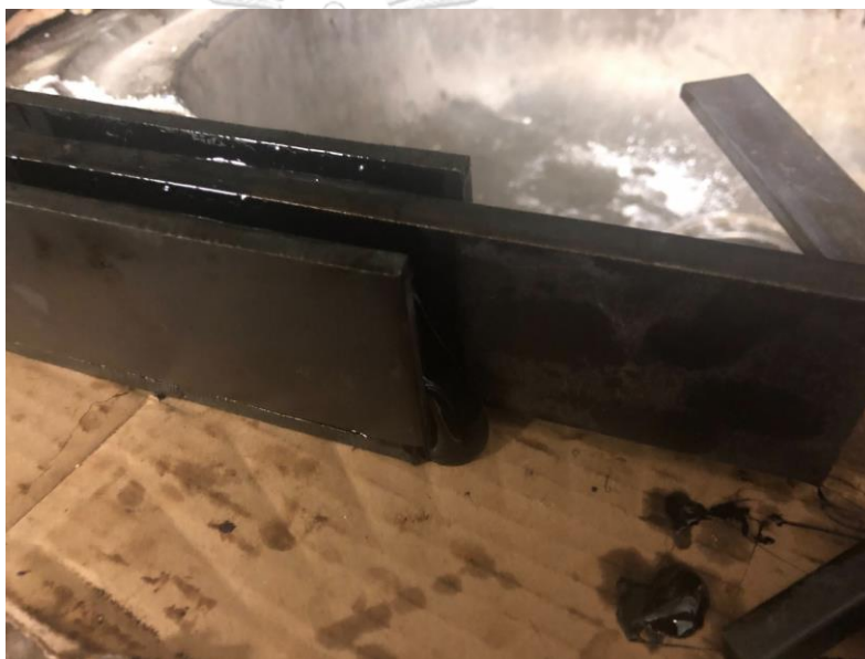
รูปที่ 3.11 สภาพการอ่อนเหลวของยางมะตอยเมื่อทิ้งไว้ที่อุณหภูมิห้องเป็นระยะเวลานาน
