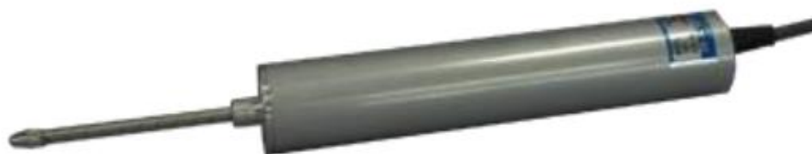
รูปที่ 3.7 อุปกรณ์วัดการขจัด LVDT
