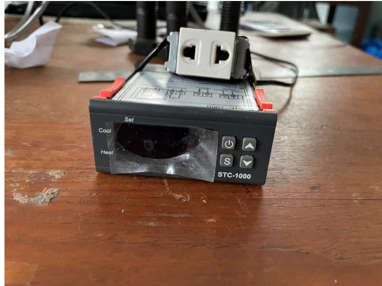
รูปที่ 3.16 อุปกรณ์ควบคุมอุณหภูมิ STC-1000
