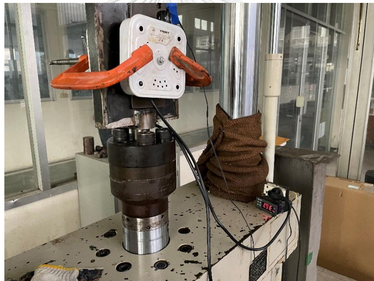
รูปที่ 3.17 การควบคุมอุณหภูมิของตัวอย่างย่อยส่วนของผนังสลายพลังงานแบบวิสโคอิลาสติก
