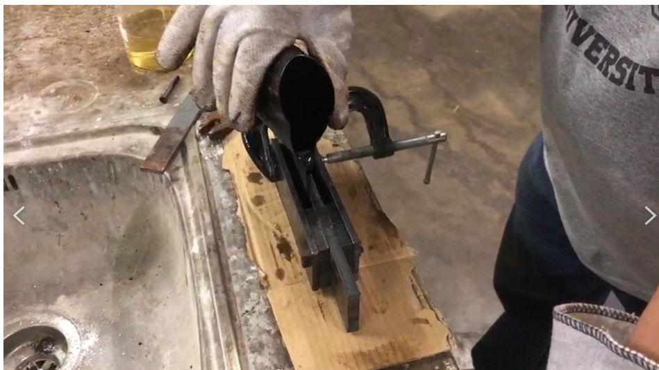
รูปที่ 3.5 การเทยางมะตอยอุ่นร้อนในตัวอย่างทดสอบ
