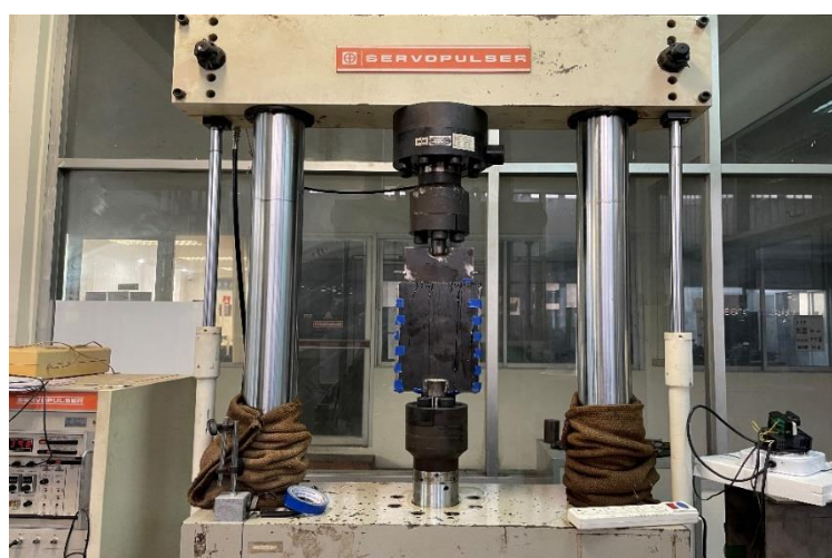
รูปที่ 3.15 เครื่องทดสอบแบบวัฏจักรขนาด 20 ตัน (Servopulser)
