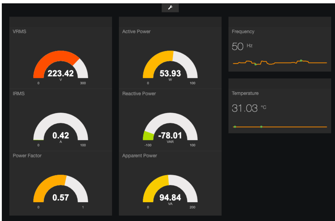
รูปที่ 63 การทดสอบส่งข้อมูลค่าพลังงานทางไฟฟ้าไปยัง NETPIE Dashboard เพื่อแสดงผล
