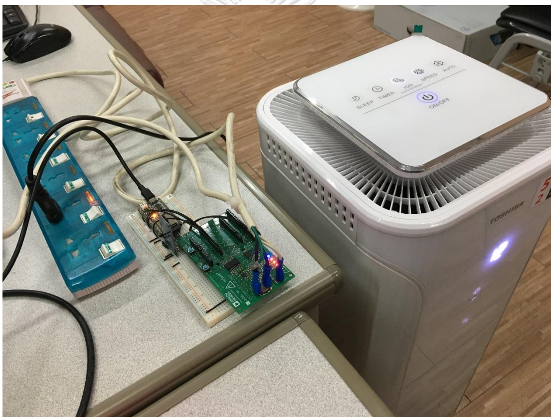
รูปที่ 51 การทดสอบวัดค่าพลังงานทางไฟฟ้าของมิเตอร์อัจฉริยะต้นแบบกับโหลด
