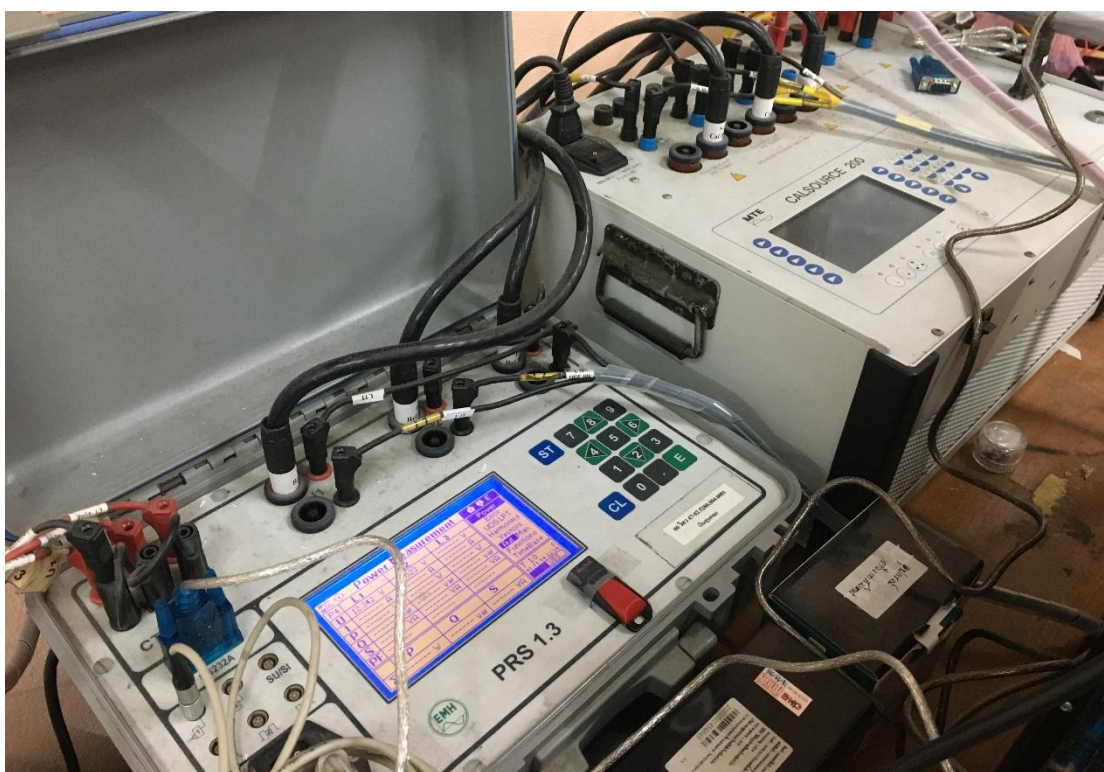
รูปที่ 54 เครื่องมือที่ใช้ในการทดสอบความผิดพลาดการวัดของมิเตอร์อัจฉริยะ
