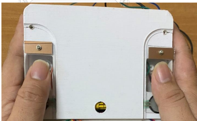
รูปที่ 4.3 การวางบนอุปกรณ์วัดสัญญาณคลื่นไฟฟ้าหัวใจชนิดสองอิเล็กทรอนิกส์แบบกระจก ITO ขณะทำการทดลอง
