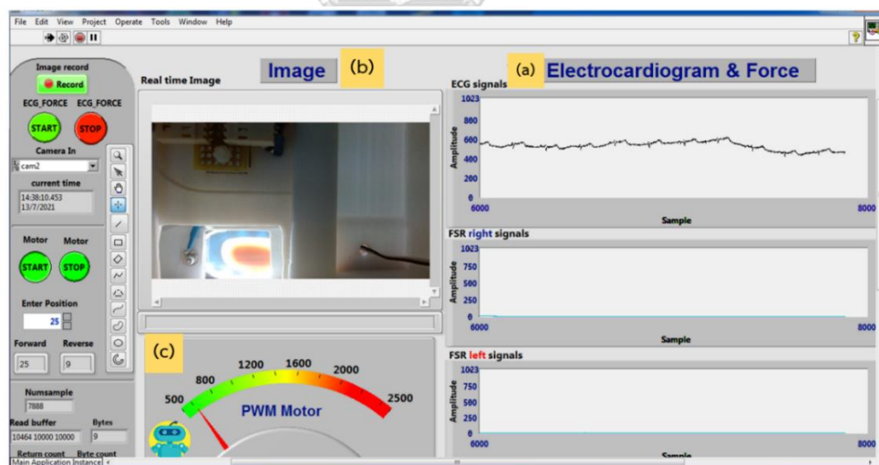
รูปที่ 3.12 ส่วนของการแสดงผลบนโปรแกรม LabView (a) แสดงผลการวัดสัญญาณคลื่นไฟฟ้าหัวใจและแรงกดของนิ้วที่กระทำต่ออิเล็กทรอนิกส์ข้างซ้ายและขวา (b) ภาพของพื้นที่สัมผัสระหว่างอิเล็กทรอนิกส์กับนิ้วหัวแม่มือ และ (c) การกำหนดมุมการหมุนของมอเตอร์เซอร์โว
