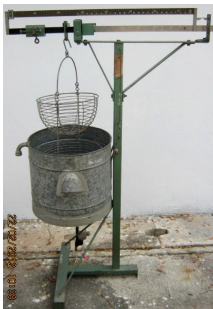
รูปที่ 2.4 เครื่องชั่งหาเปอร์เซ็นต์แฉ่งในหัวมัน (สำนักงานกลางซึ่งตวงวัด, 2559, กรมการค้าภายใน)
