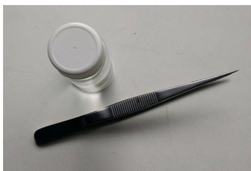
ภาพที่ 9 ปากคีบและขวดแก้วที่ใช้ในการเก็บตัวอย่าง
