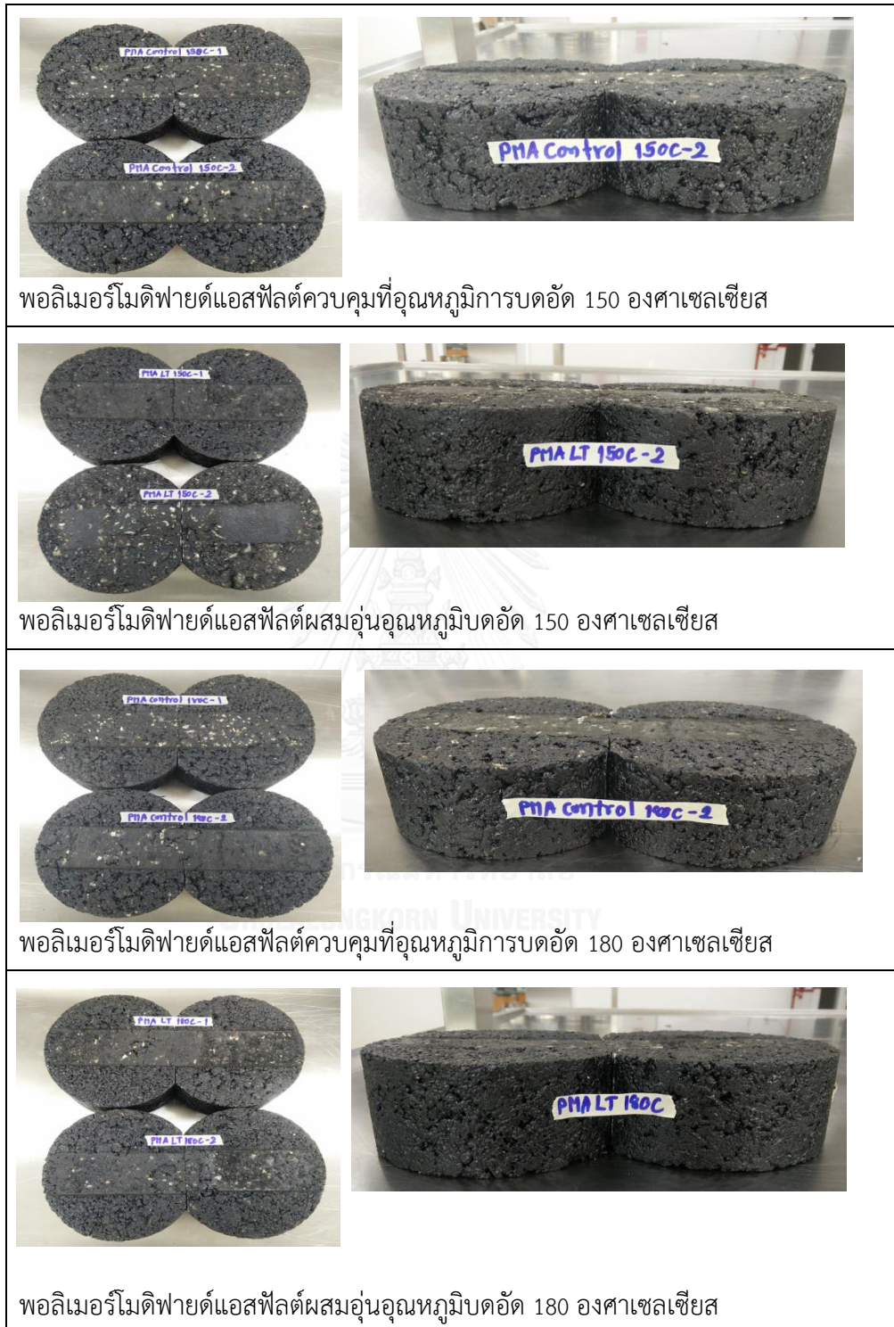
รูปที่ 4.15 แอสฟัลต์คอนกรีตตัวอย่างหลังจากผ่านการทดสอบการเกิดร่องล้อในสภาวะเปียก
