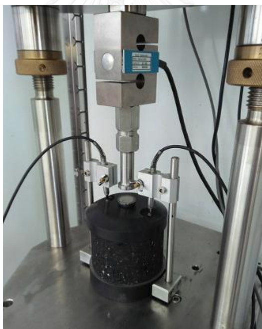
รูปที่ 3.8 ลักษณะการจัดวางก้อนตัวอย่างสำหรับทดสอบความต้านทานการเปลี่ยนรูปแบบถาวร
