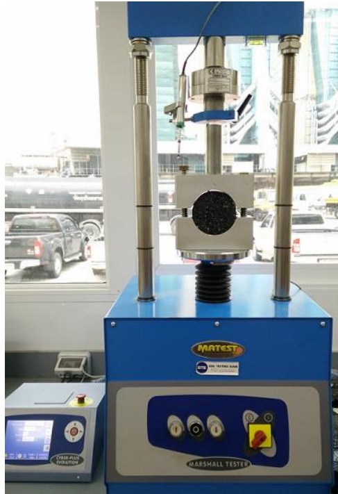
รูปที่ 2.13 เครื่องมือทดสอบเสถียรภาพและการไหลของแอสฟัลต์คอนกรีตด้วยวิธีมาร์แชล
