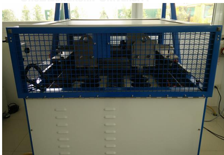
รูปที่ 3.11 แสดงการทดสอบการเกิดร่องล้อด้วยล้อสแตนเลส
