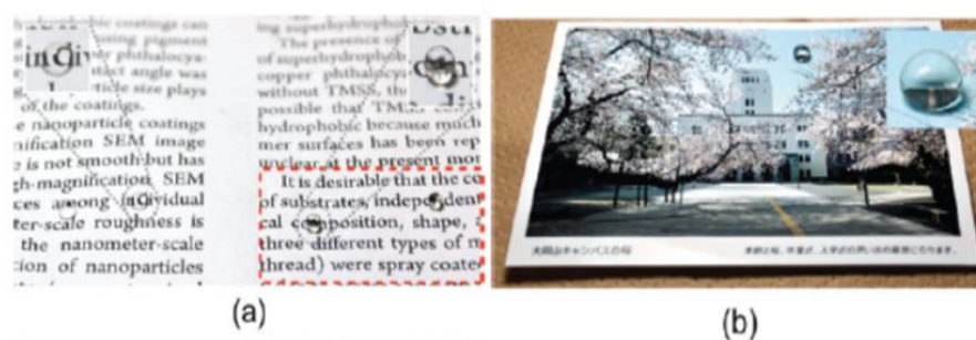
รูปที่ 2.8 ภาพหยดน้ำบน (a) กระดาษ และ (b) รูปถ่าย หลังจากการพ่นเคลือบด้วยสารละลายอนุภาคนาโนซิลิกา (อนุภาคนาโนซิลิกาเริ่มต้นขนาด 25 นาโนเมตร) [47]
