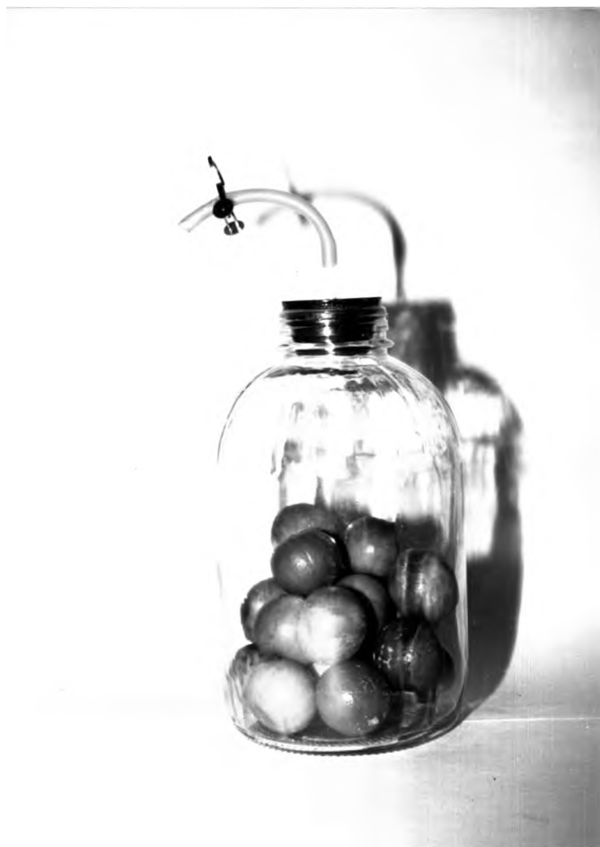
รูปที่ 3.1 ขวดปิดสนิทที่บรรจุมะนาวซึ่งใช้หาความเข้มข้นของก๊าซออกซิเจน และคาร์บอนไดออกไซด์ที่เปลี่ยนแปลงไป
