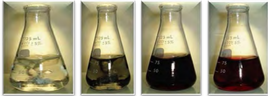
รูปที่ 1 การสังเคราะห์ AuNPs จากสารละลาย \text{HAuCl}_4 และ sodium citrate ด้วยปฏิกิริยา reduction ในอุณหภูมิที่เหมาะสม (23)
