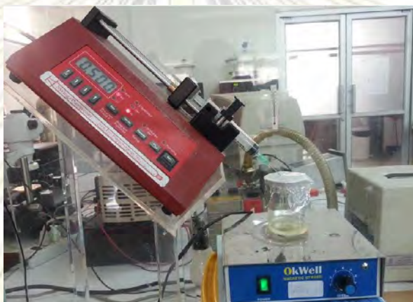
ภาพที่ 3.1 การตั้งเครื่องมือในระหว่างการเตรียมสารละลายอิมัลชัน
