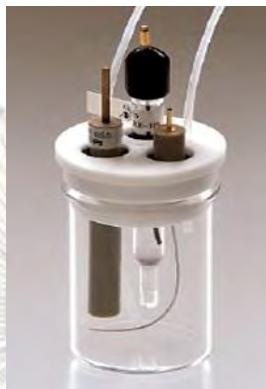
รูปที่ 2.4 เซลล์สำหรับเทคนิคไซคลิกโวลแทมเมตรี
