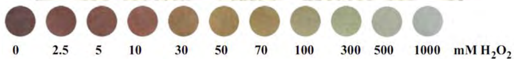
รูปที่ 2.1 การเปลี่ยนแปลงความเข้มสีของอุปกรณ์ฐานกระดาษเมื่อทำปฏิกิริยากับไฮโดรเจนเปอร์ออกไซด์ที่ความเข้มข้นต่างกัน [14]
