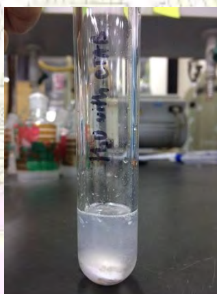
รูปที่ 3.2 สารละลายที่ไม่เป็นเนื้อเดียวกัน (multi phase) ด้วยตัวทำละลายน้ำและ CTAB
