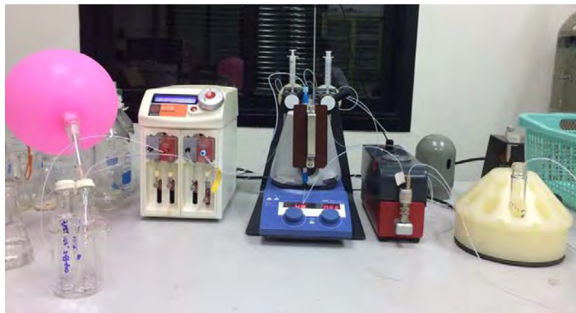
รูปที่ 1.4 เครื่องทำปฏิกิริยาซูซูโครสคัปปลิงแบบต่อเนื่องในห้องปฏิบัติการของกลุ่มวิจัย
