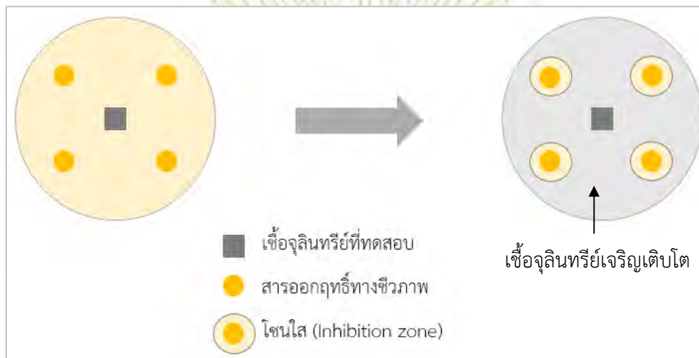
รูปที่ 1.5 แผนภาพการทดสอบฤทธิ์ในการยับยั้งเชื้อจุลินทรีย์ด้วยวิธี Agar disc diffusion
