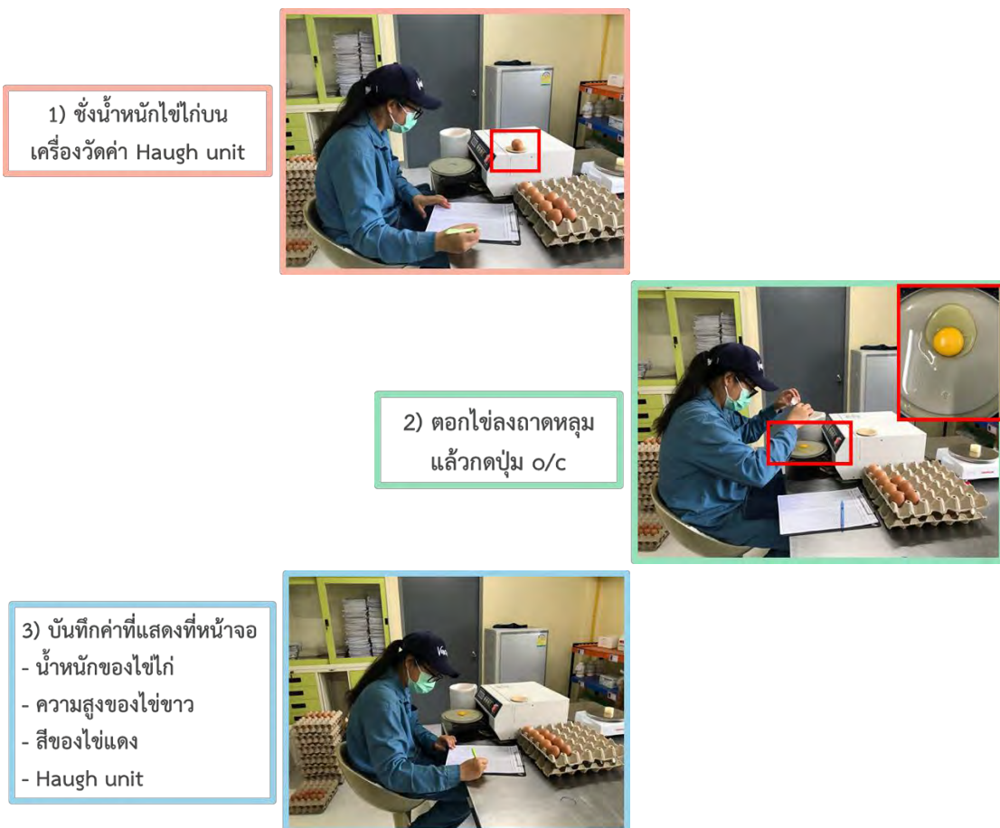
รูปที่ 3.4 แสดงวิธีการวัดความสดด้วยเครื่องวัดค่า Haugh unit
