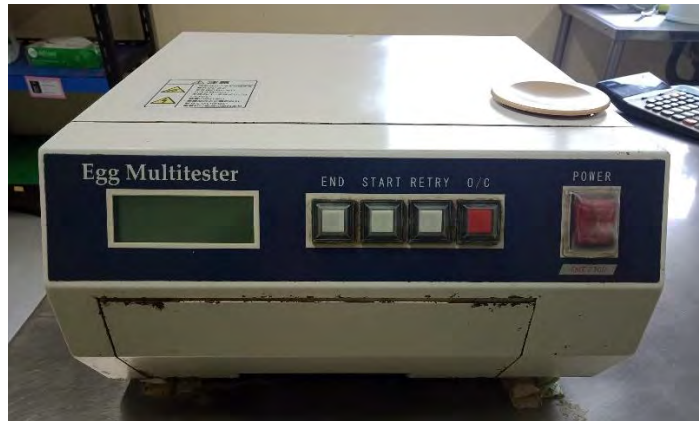
รูปที่ 3.3 เครื่องวัดค่า Haugh unit รุ่น Egg Multitester EMT7300 จากประเทศญี่ปุ่น
