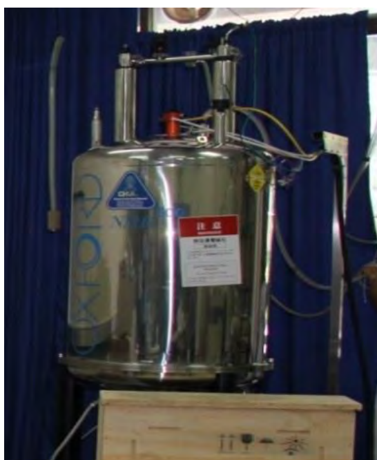
รูปที่ 3.3 เครื่องโปรตอนนิวเคลียร์แมกเนติกเรโซแนนซ์สเปกโตรมิเตอร์
