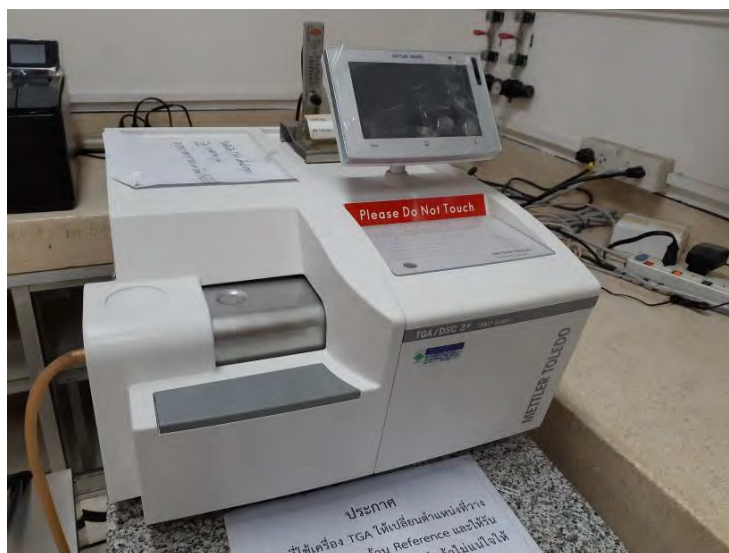
รูปที่ 3.10 เครื่องวิเคราะห์น้ำหนักภายใต้ความร้อน
