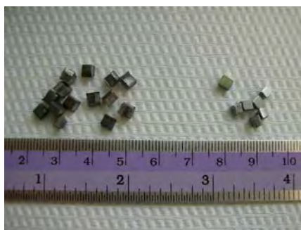
ภาพที่ 3.7 (ซ้าย) ชิ้นงานก่อนขัดลดขนาด และกำจัดออกไซด์สเกล (ขวา) ชิ้นงานที่เตรียมเสร็จแล้ว
