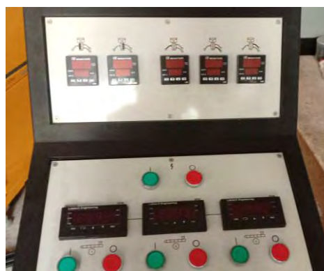
รูปที่ 3.3 แผงควบคุมอุณหภูมิเครื่อง sheet extruder บริเวณหัวตาย
