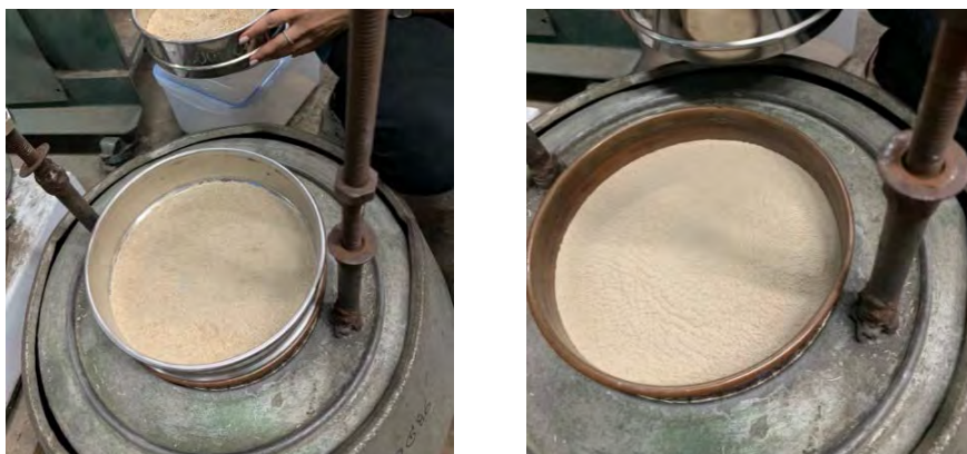
รูปที่ 3.7 (ซ้าย) ชานอ้อยชั้น -250 Micron ถึง +150 Micron (ขวา) ชานอ้อยชั้น -150 Micron
