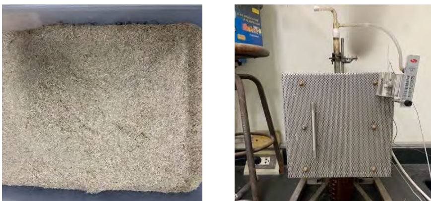
รูปที่ 3.8 (ซ้าย) ชานอ้อยที่จะนำไป Calcination (ขวา) เครื่อง Calcination
