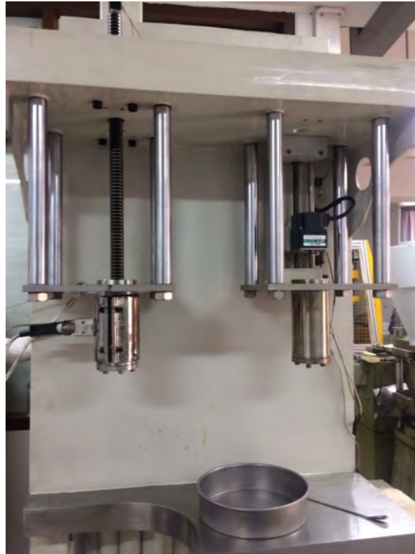
รูปที่ 14 เครื่องฉีดขึ้นรูปแบบที่มีแท่งดัน
