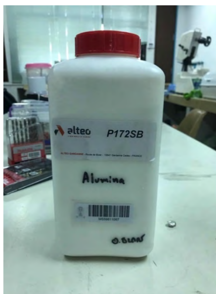
รูปที่ 11 ผงอะลูมินา alteo P172SB 0.43 ไมโครเมตร
