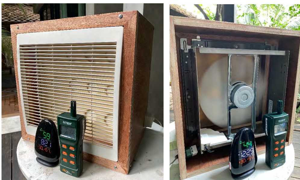
รูปที่ 3.4 การทดสอบประสิทธิภาพการดักจับฝุ่น PM2.5 และการดูดซับคาร์บอนไดออกไซด์
